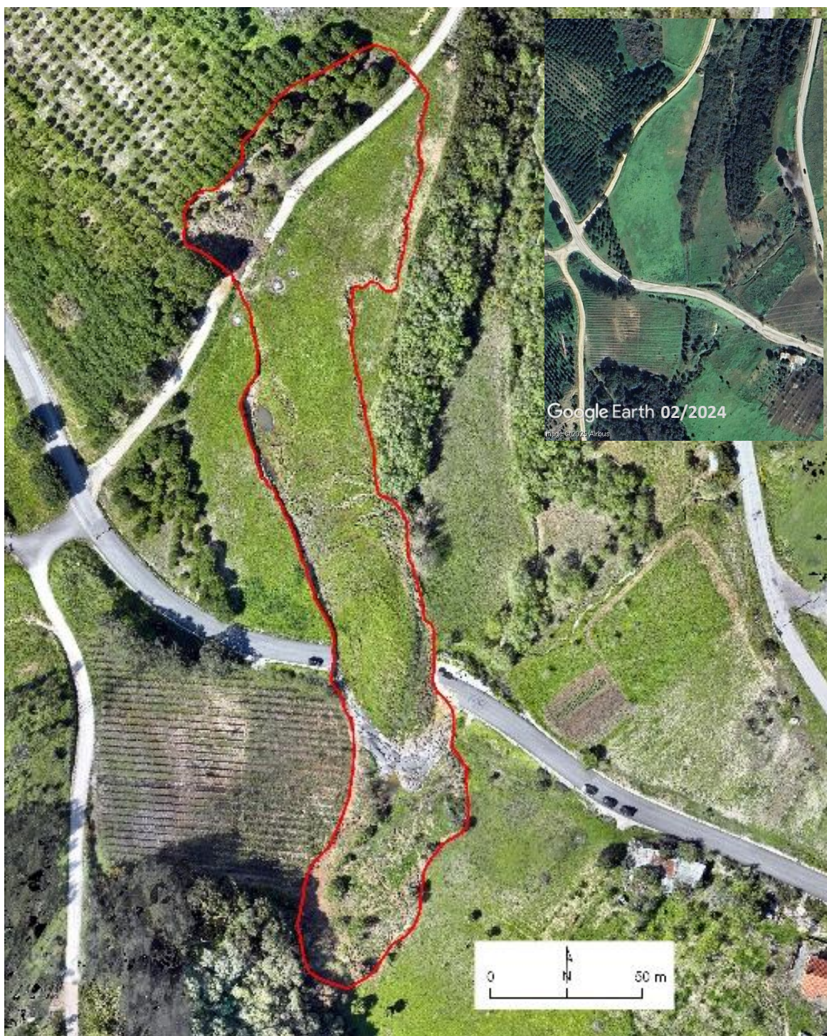
Figura 1. Ortoimagem de alta resolução do movimento de vertente complexo de A-do-Mourão obtida por UAV, com delimitação preliminar da área afetada. É visível a extensão do movimento ao longo da vertente e a destruição de um troço de estrada. No canto superior direito apresenta-se uma imagem da área em estudo em 2024, anterior à ocorrência do evento.
