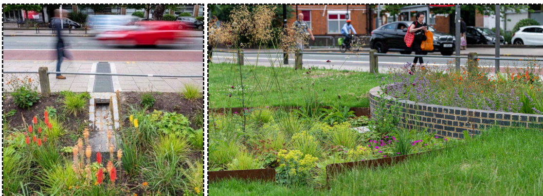
Figura 19 Sistema de entrada de água pluvial na periferia do jardim (esquerda). Rain Gardens (direita).
