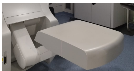
Figura 3.3: EPID de um acelerador linear TrueBeam (Varian) estendido.
