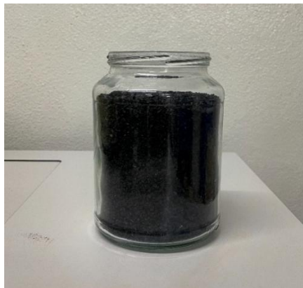
Figura 30 - Aspeto geral da borracha granulada utilizada nos ensaios experimentais.
