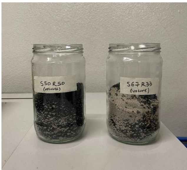
Figura 33 - Aspeto geral das amostras com diferentes composições (S50R50 e S67R33), preparadas com base em percentagens volumétricas.
