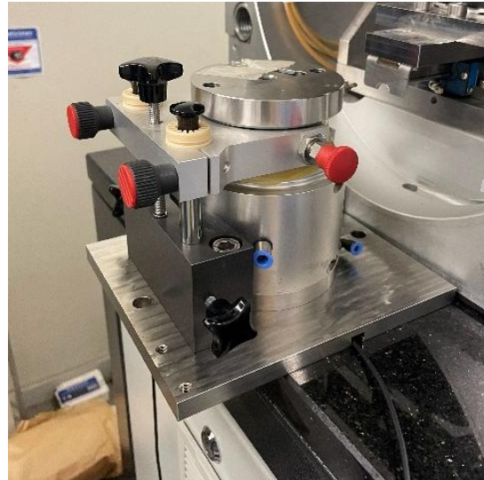
Figura 51 - Provete montado e elementos de controlo e carregamento posicionados para a realização do ensaio.
