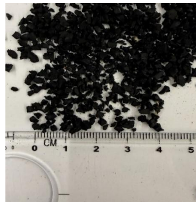
Figura 31 - Aspeto visual da amostra 100% borracha, com escala em centímetros.
