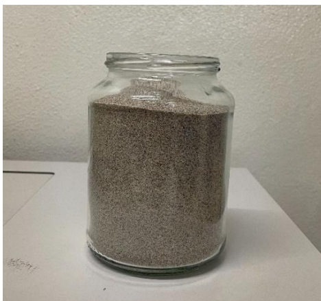
Figura 27 - Aspeto geral da areia de Hostun utilizada nos ensaios experimentais.
