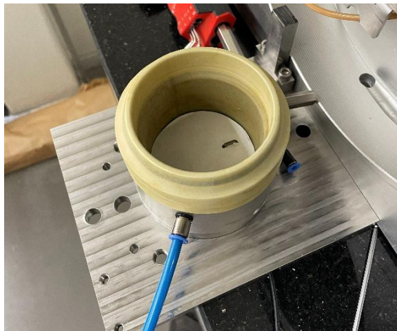
Figura 48 - Base do provete com filtro e colocação do vácuo na amostra.
