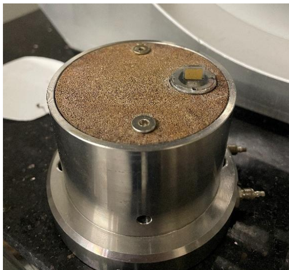
Figura 35 - Bender elements instalados na base da câmara de ensaio.
