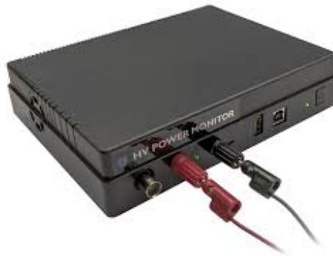
Figura 4.4: Monsoon High Voltage Power Monitor (HVPM) utilizado nas sessões de medição de energia [18].
