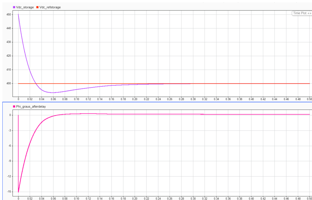
Figura 4.7: Regulação da tensão do armazenamento durante o ensaio de descarregamento.
