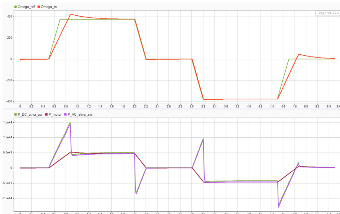
Figura 4.4: Velocidade angular do motor e fluxos de potência do acionamento.
