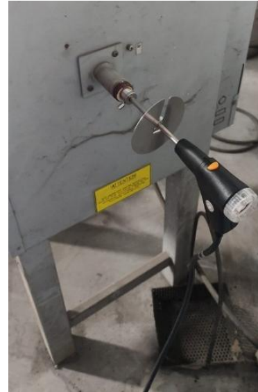
Figura 15. Orifício lateral do forno onde foram realizadas as medições com a sonda.
