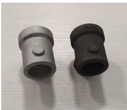
Figura 25. Peça granalhada e a mesma peça tratada termicamente nas condições do Ensaio 1.
