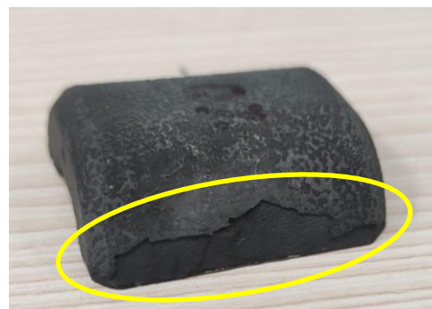
Figura 34. Carepa oxidada destacada pelo corte transversal de uma peça tratada no Ensaio 1 (rodeada a amarelo).
