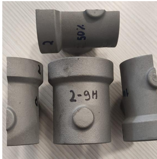
Figura 30. Comparação da superfície das peças em aço GX5CrNiMo19-11-2, após granalhagem; é notória uma camada mais rugosa na peça com estágio de 9 horas.
