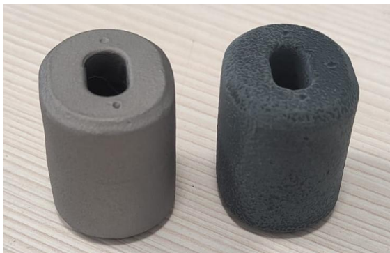
Figura 31. Peça tratada termicamente nas condições do Ensaio 2 e a mesma peça granalhada.
