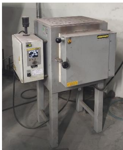
Figura 12. Forno de mufla utilizado no tratamento térmico das peças em análise.
