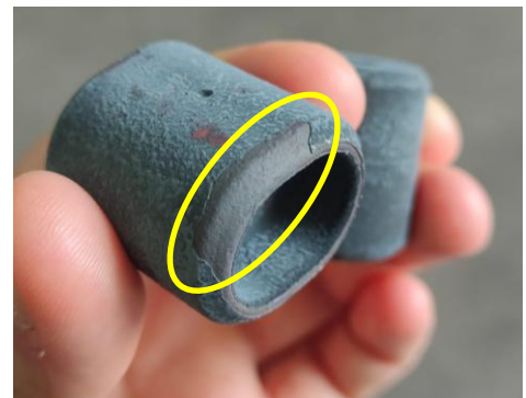
Figura 32. Carepa destacada de uma peça tratada no Ensaio 1 (rodeada a amarelo).
