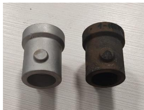
Figura 26. Peça granalhada e a mesma peça tratada termicamente nas condições do Ensaio 3.
