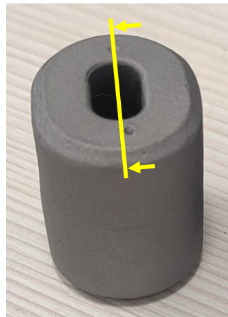
Figura 19. Indicação da direção de corte transversal das peças em aço de baixo carbono (linha amarela).
