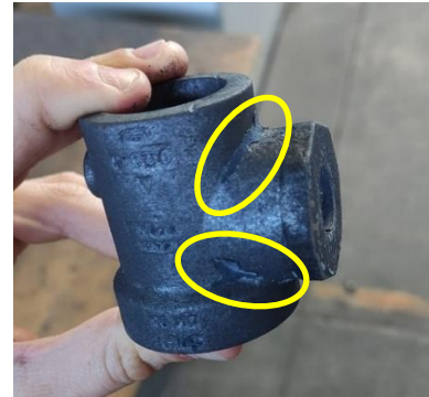
Figura 28. Carepa destacada de uma peça tratada no Ensaio 4 (rodeada a amarelo).
