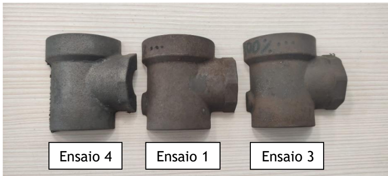
Figura 27. Comparação da camada oxidada das peças tratadas termicamente nas condições do Ensaio 4, Ensaio 1 e Ensaio 3, respectivamente.
