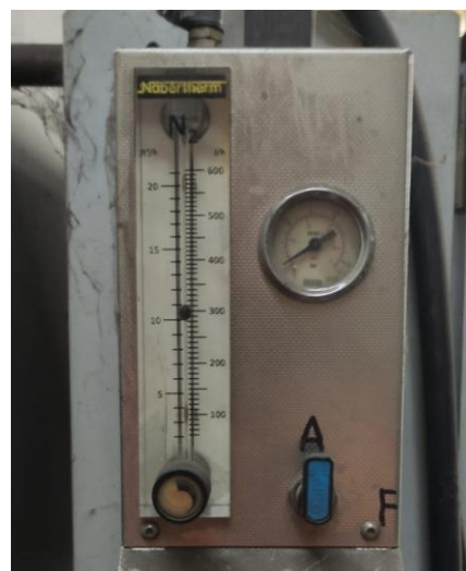
Figura 13. Manómetro para controlo do fluxo de \text{N}_2 injetado no forno, variando este entre os 0 e os 600 L/h.
