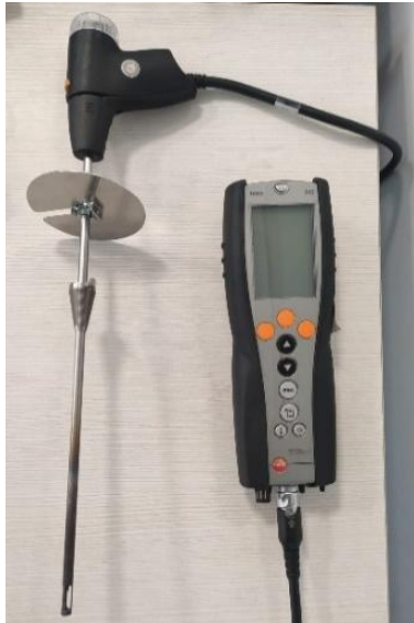
Figura 14. Sonda de medição do potencial de O_2 , utilizado neste trabalho para medir o potencial de oxigênio da atmosfera do forno.
