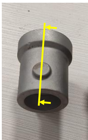
Figura 18. Indicação da direção de corte transversal das peças em aço inoxidável austenítico (linha amarela).
