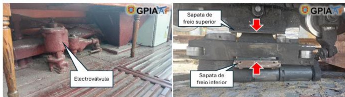
Figura 4 – Eletroválvula de acionamento do freio automático (à esquerda) e sapatas de freio do trambolho (à direita), componentes analisados no âmbito da investigação dos sistemas de travagem do Ascensor da Glória. Fonte: GPIAAF (2025).
