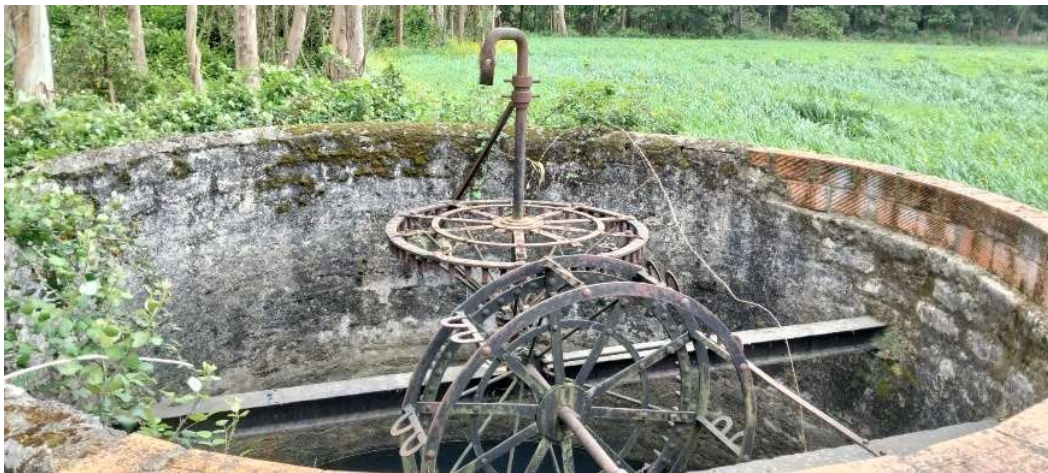
Figura 27 - Um desses sistemas com o mecanismo metálico quase completo, falta os copos e o braço de acionamento. Registo de Abril de 2026
