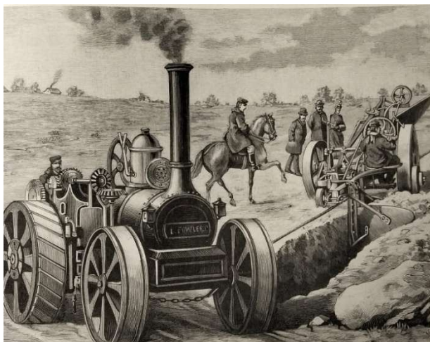
Figura 20 - Locomóvel, segundo sistema patenteado em 1856 pelo inglês John Fowler. (Paulitz, s. d.)
