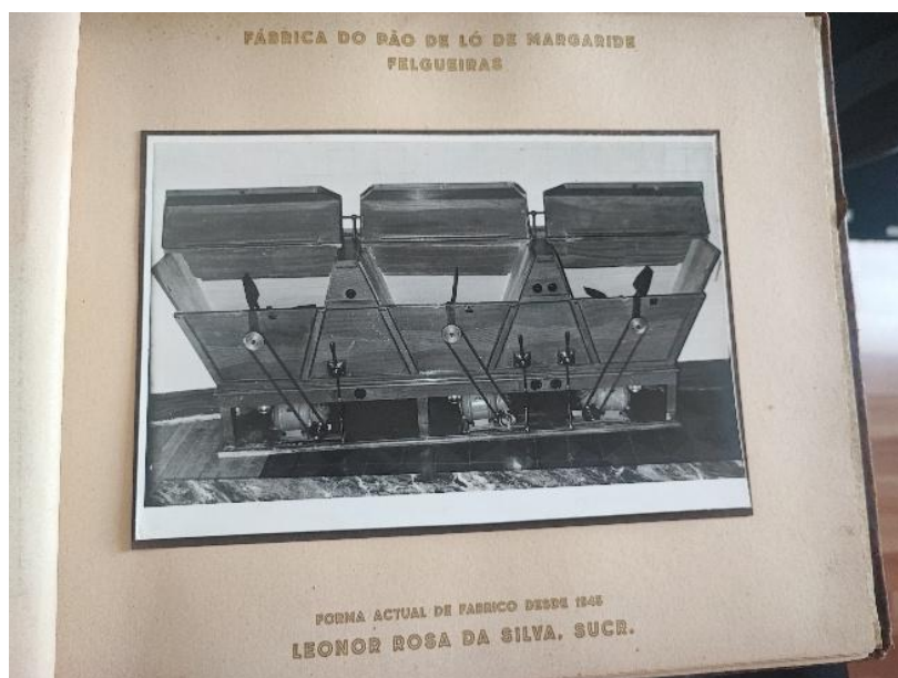
Figura 51 – Registo Fotográfico da implementação dos motores elétricos nos engenhos. (Imagem de autoria própria, fotografada a 30 de maio de 2025)
