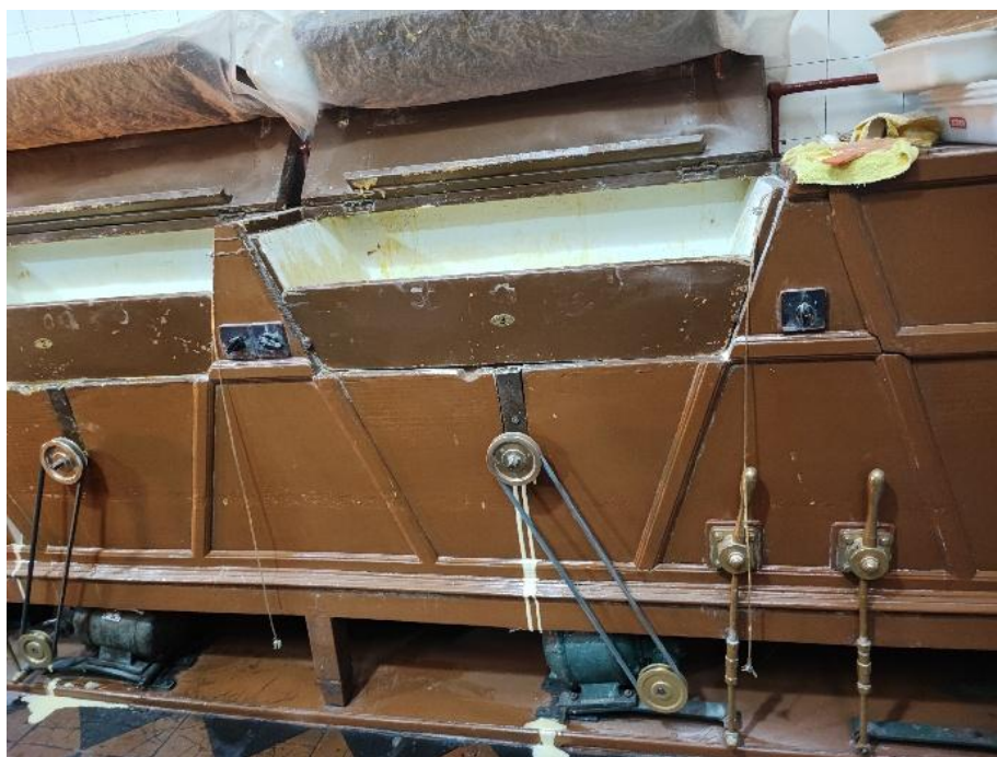
Figura 54 – Engenho em funcionamento no final da preparação da massa. (Imagem de autoria própria, fotografada a 5 de junho de 2025)
