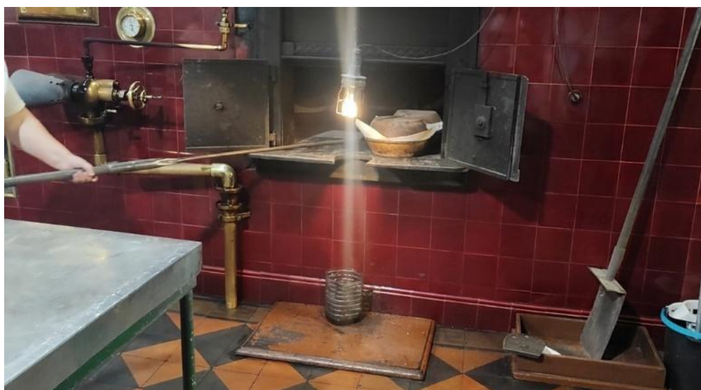
Figura 36 – Remoção das formas do forno. (Imagem de autoria própria, fotografada a 5 de junho de 2025)
