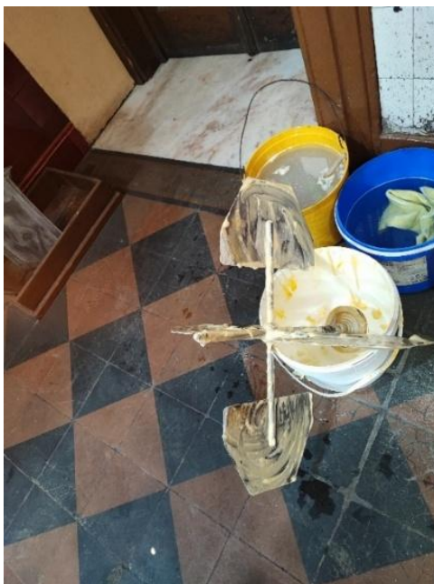
Figura 48 - Misturador de quatro pás após utilização. (Imagem de autoria própria, fotografada a 5 de junho de 2025)
