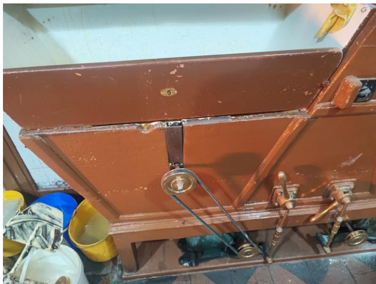
Figura 19 – Engenho (batedeira) acionado por motor elétrico. (Imagem de autoria própria, fotografada a 5 de junho de 2025)
