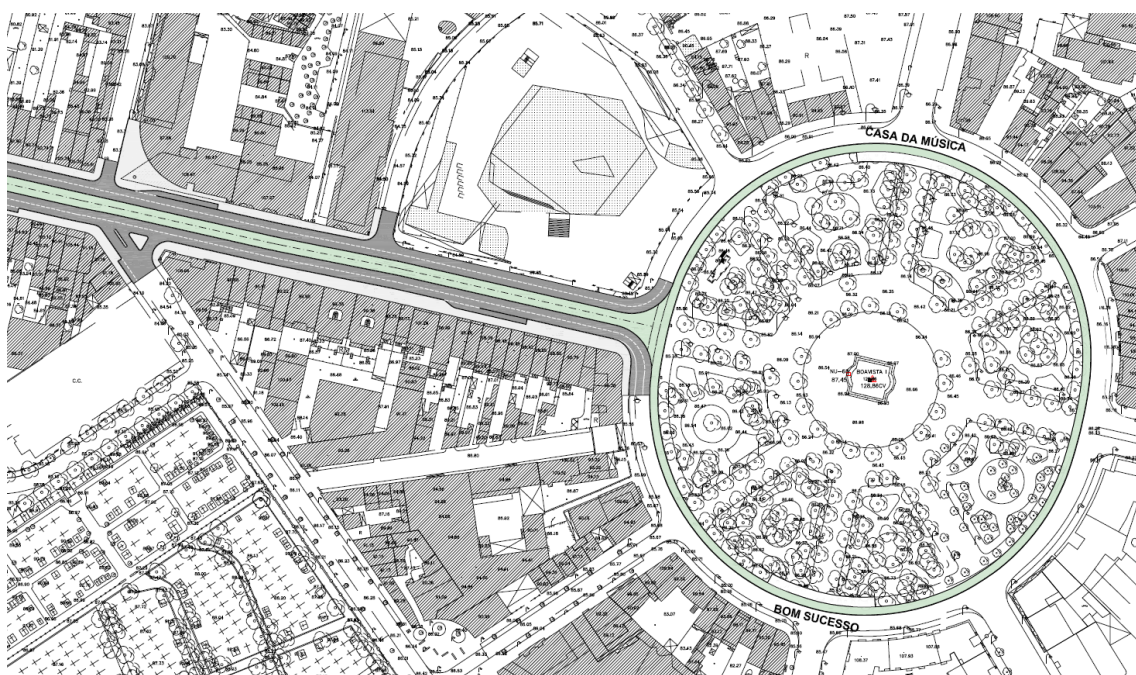
Figura 57 - Secção da peça desenhada P-PR-BB-8400-GE-DS-000003-00 (‘‘planta do troço na avenida da Boavista’’), s/escala, onde é possível observar a circulação pelo interior da Praça Mouzinho de Albuquerque e as duas rampas de acesso ao parque de estacionamento da Casa da Música, localizadas nos passeios laterais, a norte e a sul. Fonte: Metro do Porto S.A., 2021)
