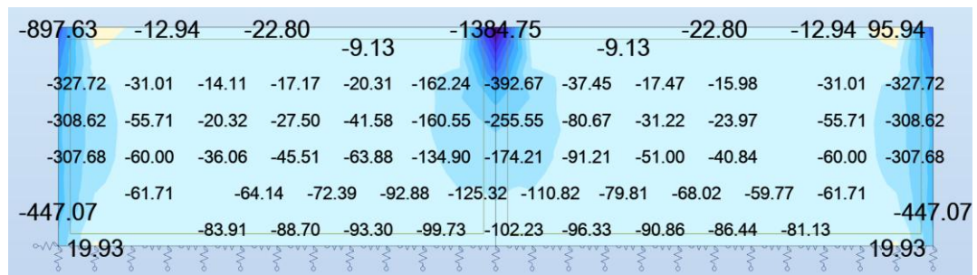
Figura 18 - Paredes de 12 m com apoios elásticos, na direção y
