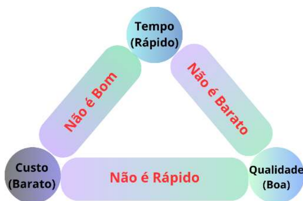
Figura 7 - Paradoxo na construção - Qualidade, Custo e Tempo [36]
