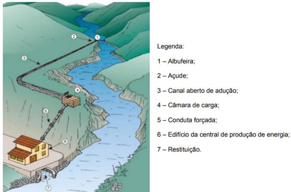
Fig. 2.9 - Esquema conceptual de um aproveitamento mini-hídrico convencional em zona de cabeceira (Fuentes BARGUES & Ferrer-Gisbert, 2015).
