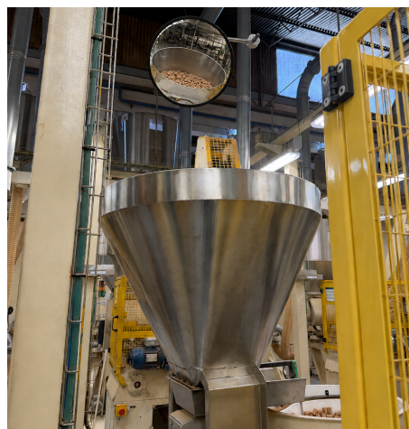
Figura 4.4: Solução proposta para a monitorização visual das moegas das máquinas intermédias.
