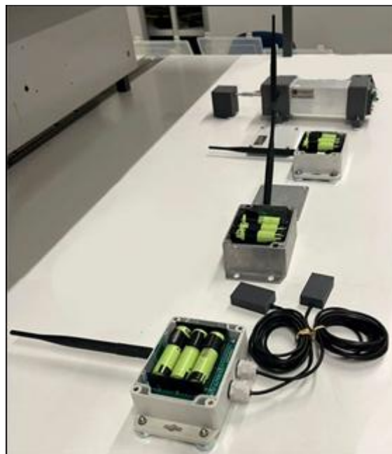
Figura 2.13 - Diferentes sensores de aquisição de dados (temperatura à esquerda, dois acelerómetros diferentes no centro e deslocamento à direita).
