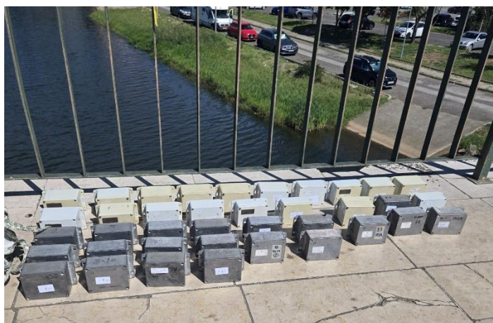
Figura 6.7 - Preparação e sincronização dos sensores antes do ensaio de vibração ambiental.
