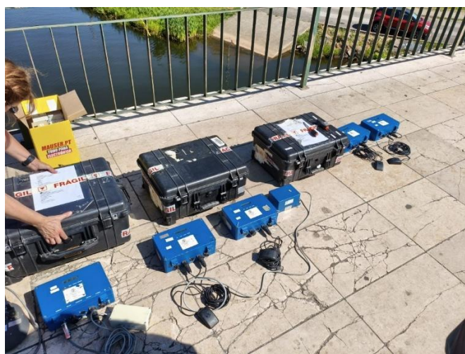
Figura 2.7 - Preparação dos equipamentos de aquisição durante o ensaio de vibração ambiental.
