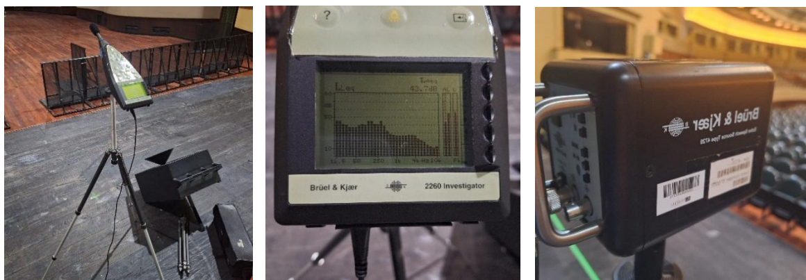
Figura 5.11, 5.12 e 5.13 – Equipamento de medição: Sonómetro Brüel & Kjær 2260 e Fonte Sonora Brüel & Kjaer 4224, resultado obtido durante um ensaio realizado e Fonte Sonora Brüel & Kjaer 4720, respectivamente [fotos da autora].
