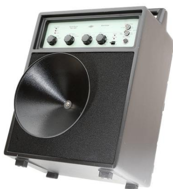
Figura 5.7 e 5.8 – Equipamentos de medição: Fonte Sonora Brüel & Kjær 4224 e exemplo de utilização do Software DIRAC [71][70].
