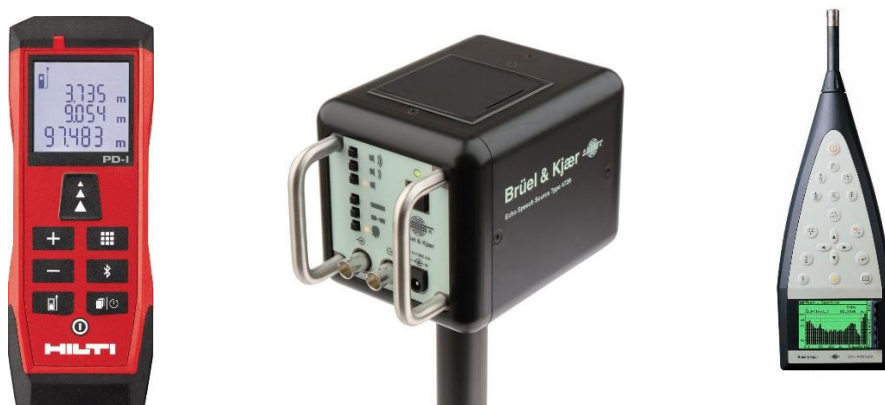
Figura 5.1, 5.2 e 5.3 – Equipamentos de medição: Medidor a Laser Hilti PD-I, Fonte Sonora Brüel & Kjær 4720 e Sonómetro Brüel & Kjær 2260, respectivamente [64][65][72].
