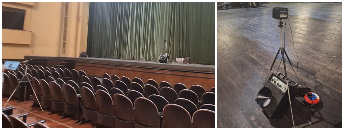
Figura 5.16 e 5.17 – Realização do estudo no ponto P1, com Sonómetro aplicado no tripé, durante o 2º ensaio (esq.), e fontes sonoras colocadas no palco, durante o 1º ensaio (dir.) [fotos da autora].
