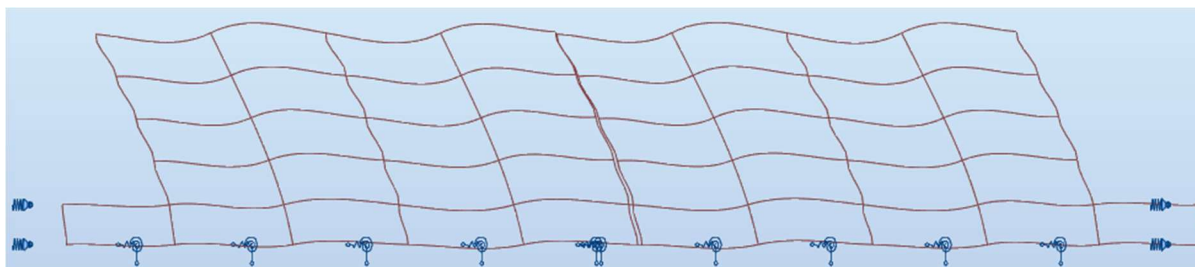
Figura 4.6 – Terceiro modo de vibração, considerando um bloco inabitado ( f_3 = 3,76\text{Hz} ).
