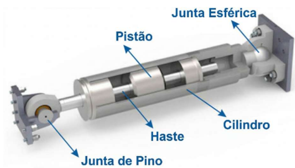
Figura 2.19 – Constituição do amortecedor viscoso [29], com tradução de texto gerada por IA.
