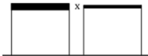
Figura 2.14 – Colisão entre edifícios de massas diferentes [26].
