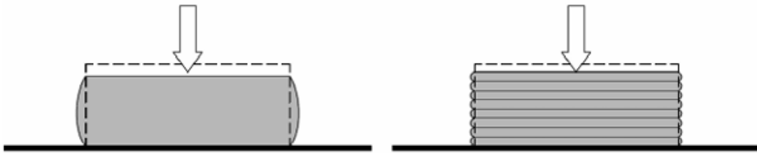
Figura 25- Variação da forma de um bloco cintado e não cintado quando sujeito à compressão (adaptado de Guerreiro, 2003)
