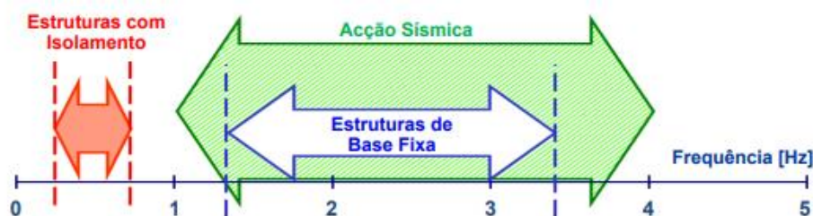
Figura 6- Intervalo usual das frequências de excitação das ações sísmicas, com maior conteúdo energético, e gama de frequências próprias das estruturas de base fixa e das estruturas com isolamento (Guerreiro, 2004)
