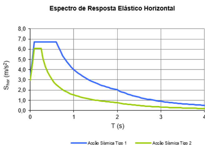
Figura 58- Espectro de Resposta de cálculo horizontal para \xi=10\%
