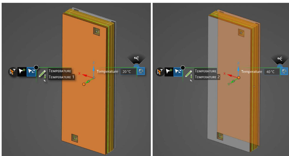
Fig. 17 – Temperaturas superficiais na face interior e exterior.
