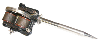
Fig. 14 - Caneta Elétrica, uma das componentes do sistema duplicador. Thomas Edison. 1876.
