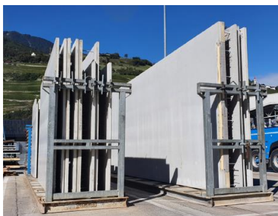
Figura 4.5 – Paredes duplas transportadas verticalmente [17]
