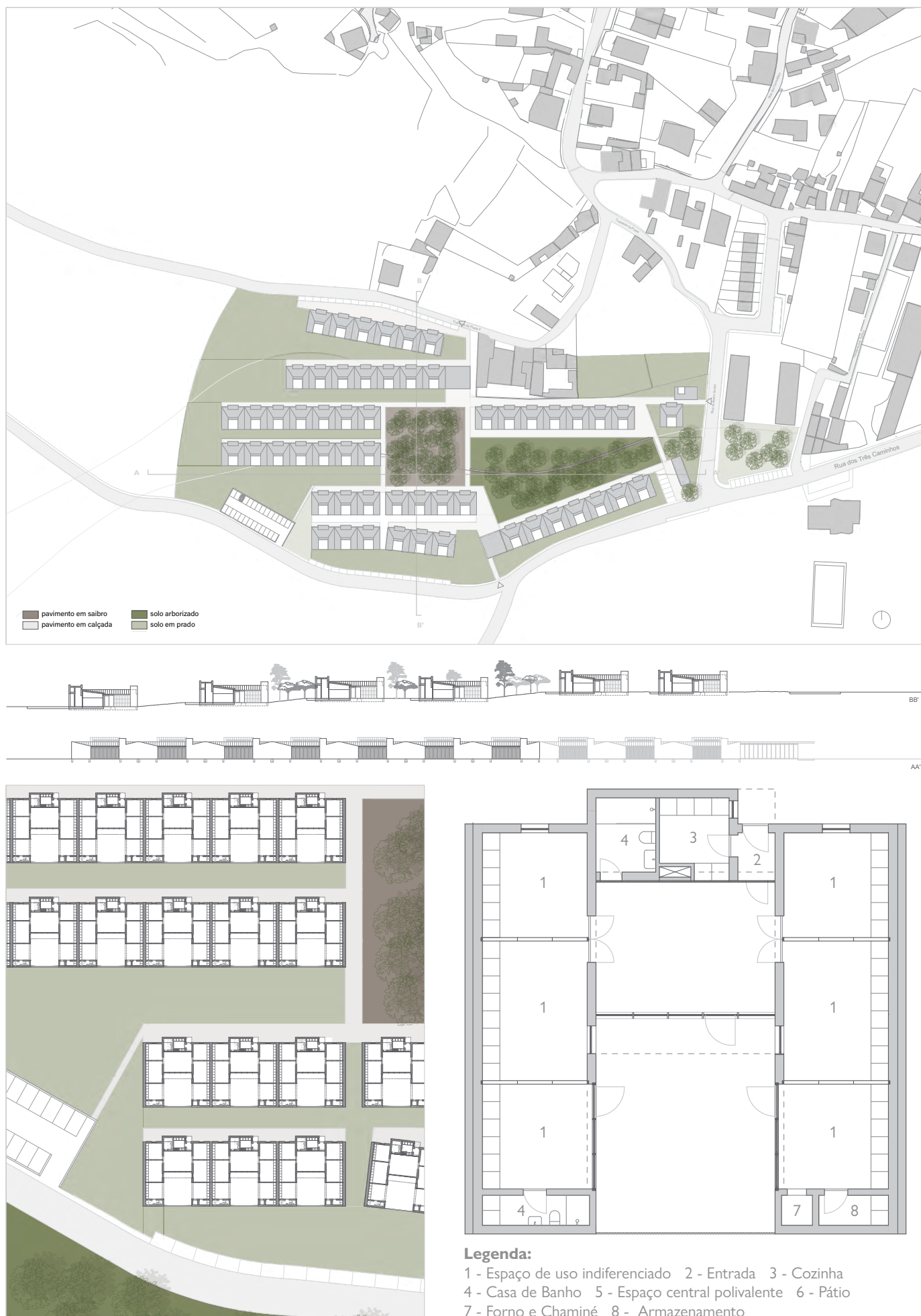
Fig. 25. Projeto de agrupamento de casas em três escalas de representação, planta de implantação à escala 1:2000, corte e alçado a 1:500, planta aproximada a 1:500, planta da casa a 1:100 (de cima para baixo)
