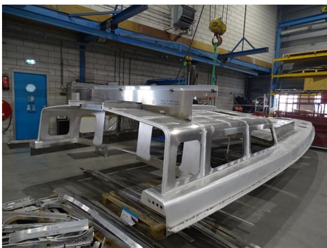
Fig. 48 - Convés construído em alumínio
