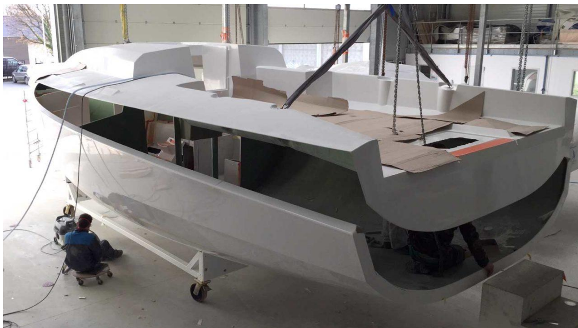
Fig. 62 - Ligação entre o casco e o convés do JPK 11.80
