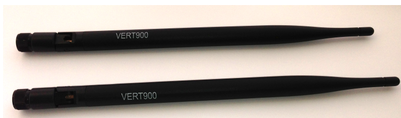
Figura 3.8: Antenas de GSM-900/DCS-1800 utilizadas no sistema
