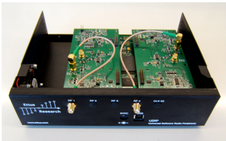
Figura 2.9: USRP1 da Ettus Research , com um rádio para envio e outro rádio para recepção
