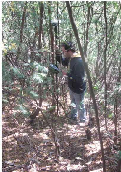
Figura 5 - Levantamento em modo cinemático
