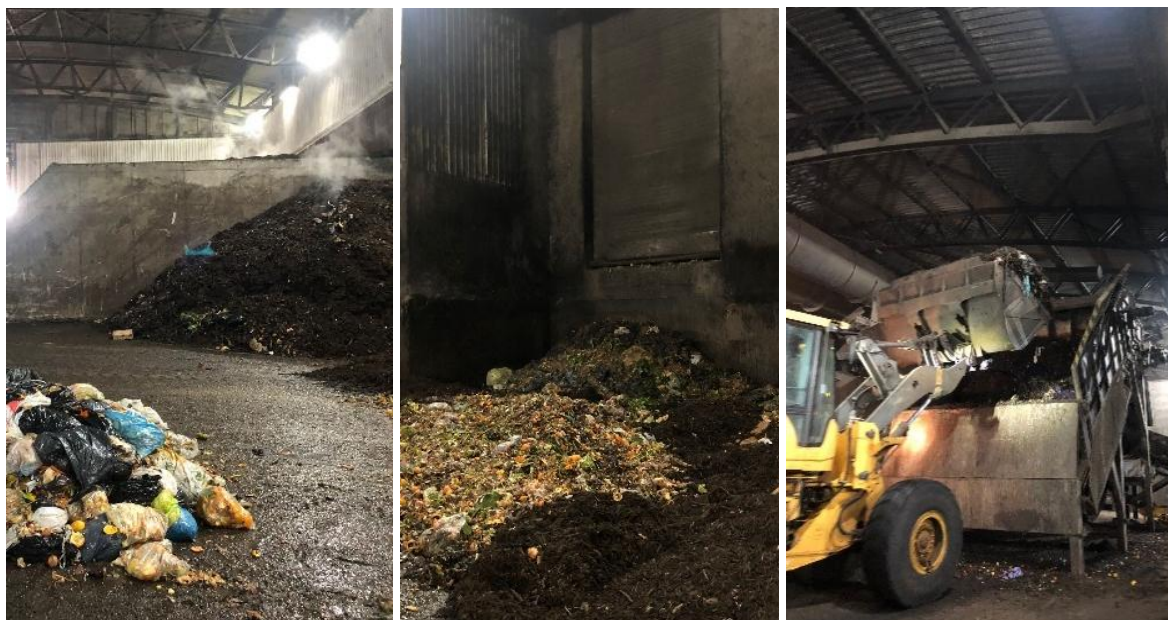
Figura 5 (i) Restos alimentares e (ii) resíduos verdes provenientes da recolha seletiva de biorresíduos, encaminhados para valorização orgânica; (iii) materiais submetidos à crivagem inicial, etapa fundamental do processo de tratamento, que permite a separação de frações indesejáveis e a obtenção de uma granulometria mais homogênea, adequada às fases subsequentes do processo de compostagem (Fonte: autora).
