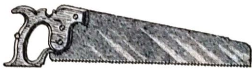
Figura 116. Serrote ordinário ou sem costas. Ilustração de COLARES, 19--; 21.
