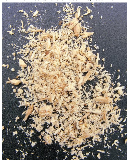
Figura 113. Serragem feita de madeira de pinho com serra manual. 2009. Fotografia de Rasbak, in Wikipédia.
