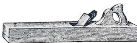
Figura 74. Garlopa. Ilustração de COLARES, 19--: 28.
