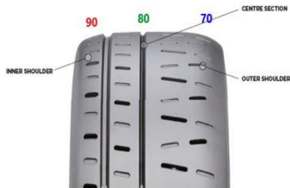
Figura 2.23: Exemplo de camber negativo excessivo [14].
