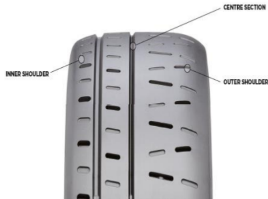
Figura 2.22: Medida de temperatura em pontos de um pneu [14].
