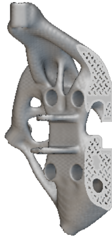
Figura 5.10: Secção de corte da peça com a field optimization aplicada.
