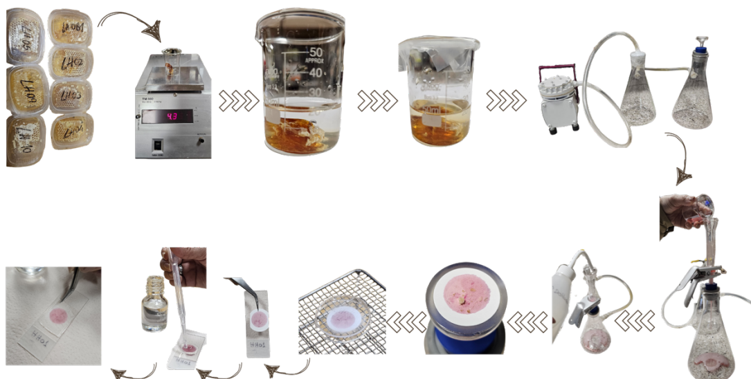
Figura 6. Etapas do procedimento laboratorial de preparação de amostras de mel para análise polínica
