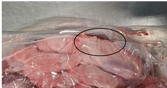
Figura 9 - Exemplo de embalagem não conforme: perfuração do filme (elaboração própria)
