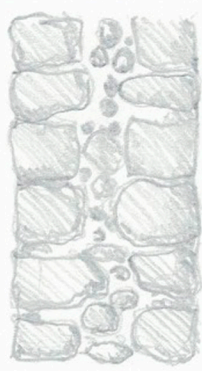
paramento duplo sem ligação
