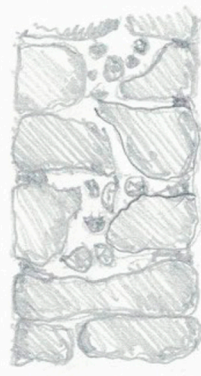
paramento duplo com ligação
