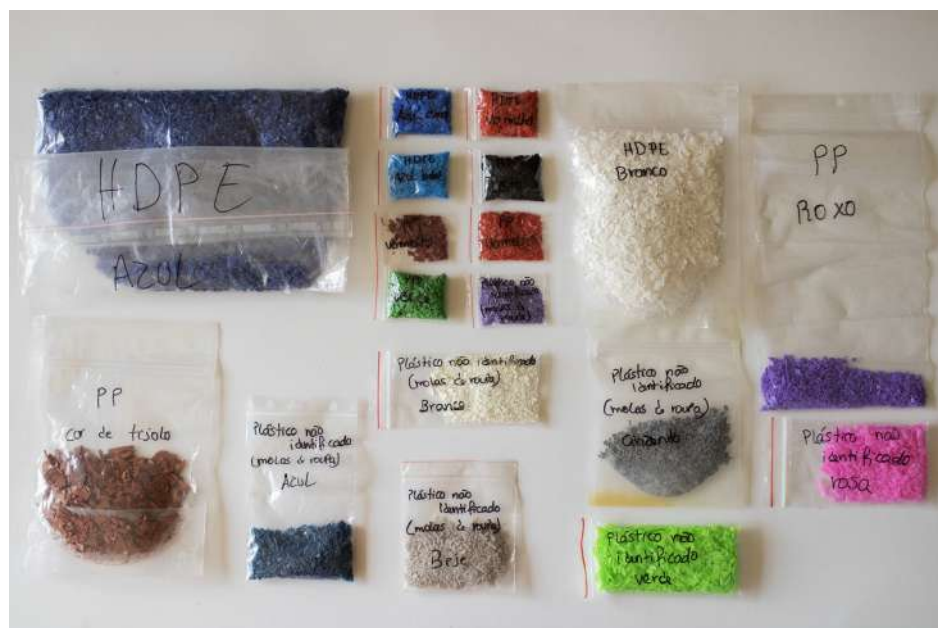
Figura 31. Plástico triturado, separado por cores e tipo de composição
