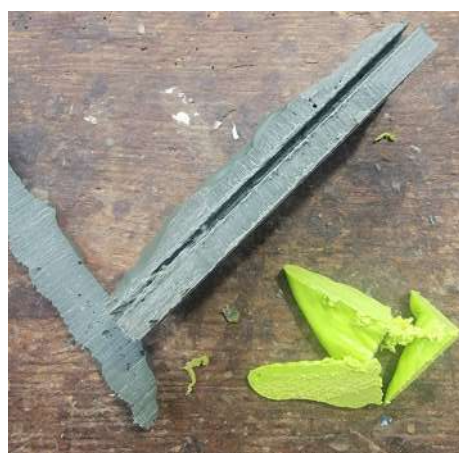
Figura 57. Corte resultante da serra circular de bancada
