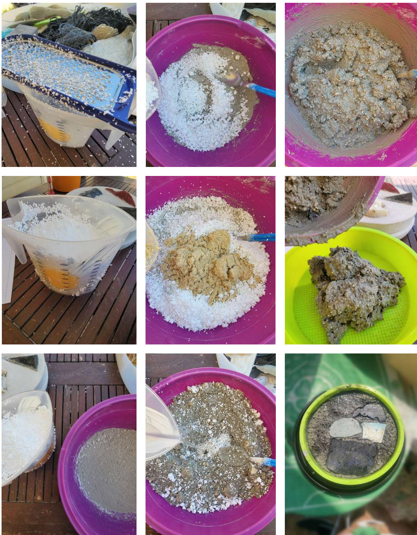
Figura 77. Processo de produção do teste de densidade (Experiência 5)
