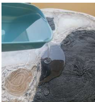
Figura 92. Aplicação da resina no tampo (1ª camada)
