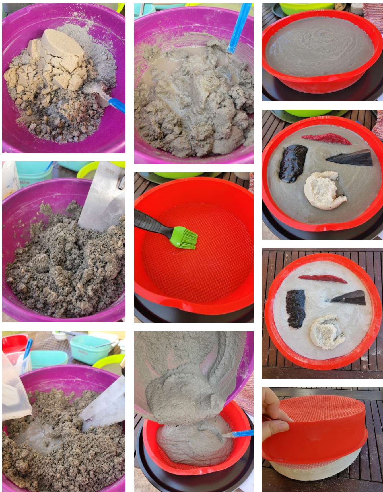
Figura 75. Processo de produção do teste de resistência e estabilidade (Experiência 2)
