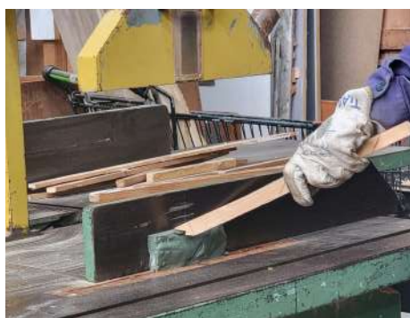
Figura 56. Corte de ranhura na amostra, utilizando a serra circular de bancada
