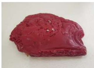
Figura 39. Purgas em PP, geradas pela limpeza de máquina de injeção
