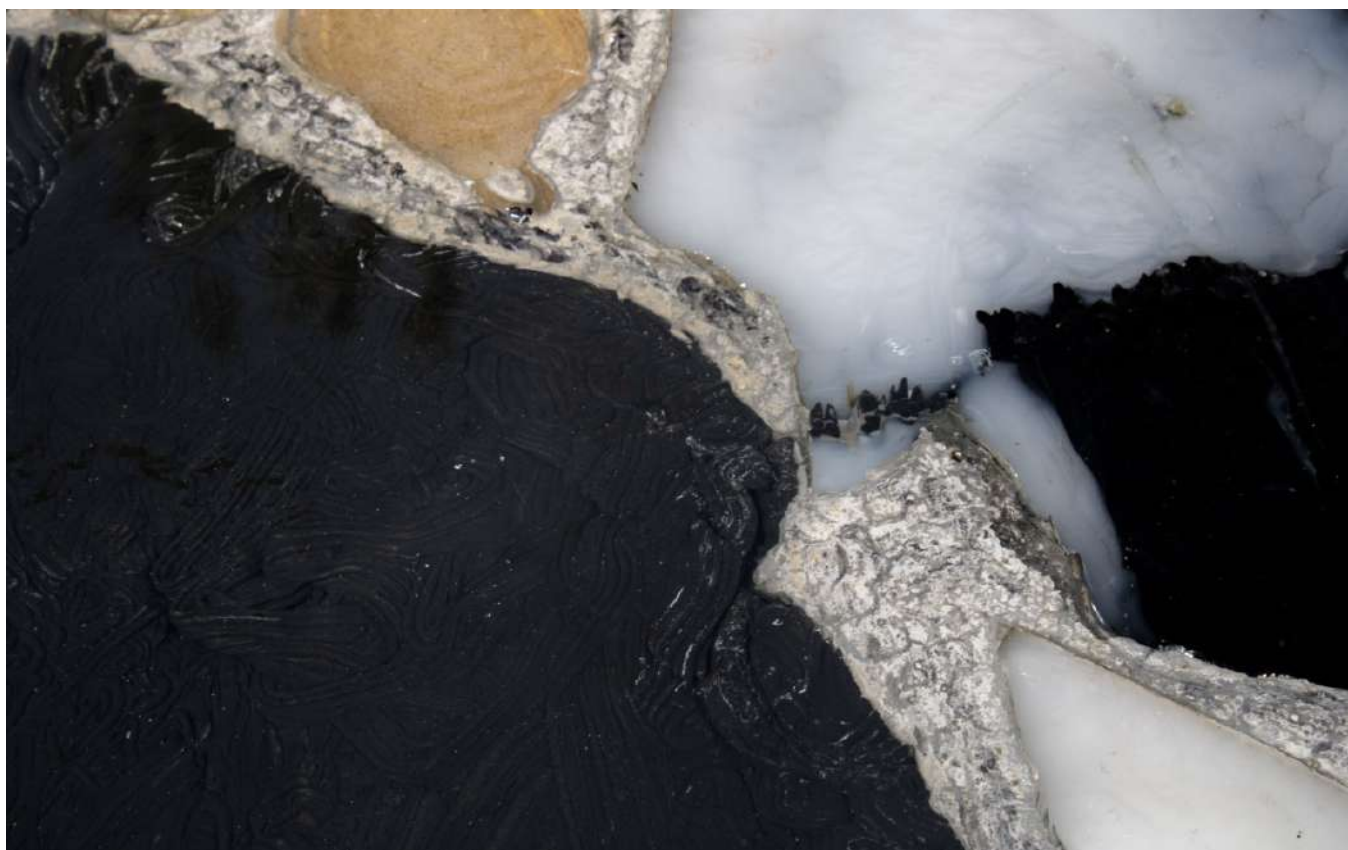
Figura 105. Detalhes da integração do cimento com as purgas plásticas, evidenciando as suas texturas irregulares
