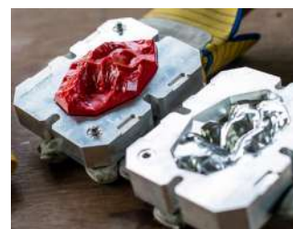
Figura 14. Abertura de molde de injeção, da produção dos souvenirs (SUPER LOCAL, s.d.)
