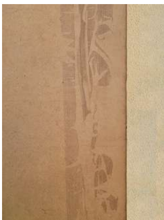
Figura 120. Tábua de madeira disponibilizada, com destaque para o defeito provocado por fita cola
