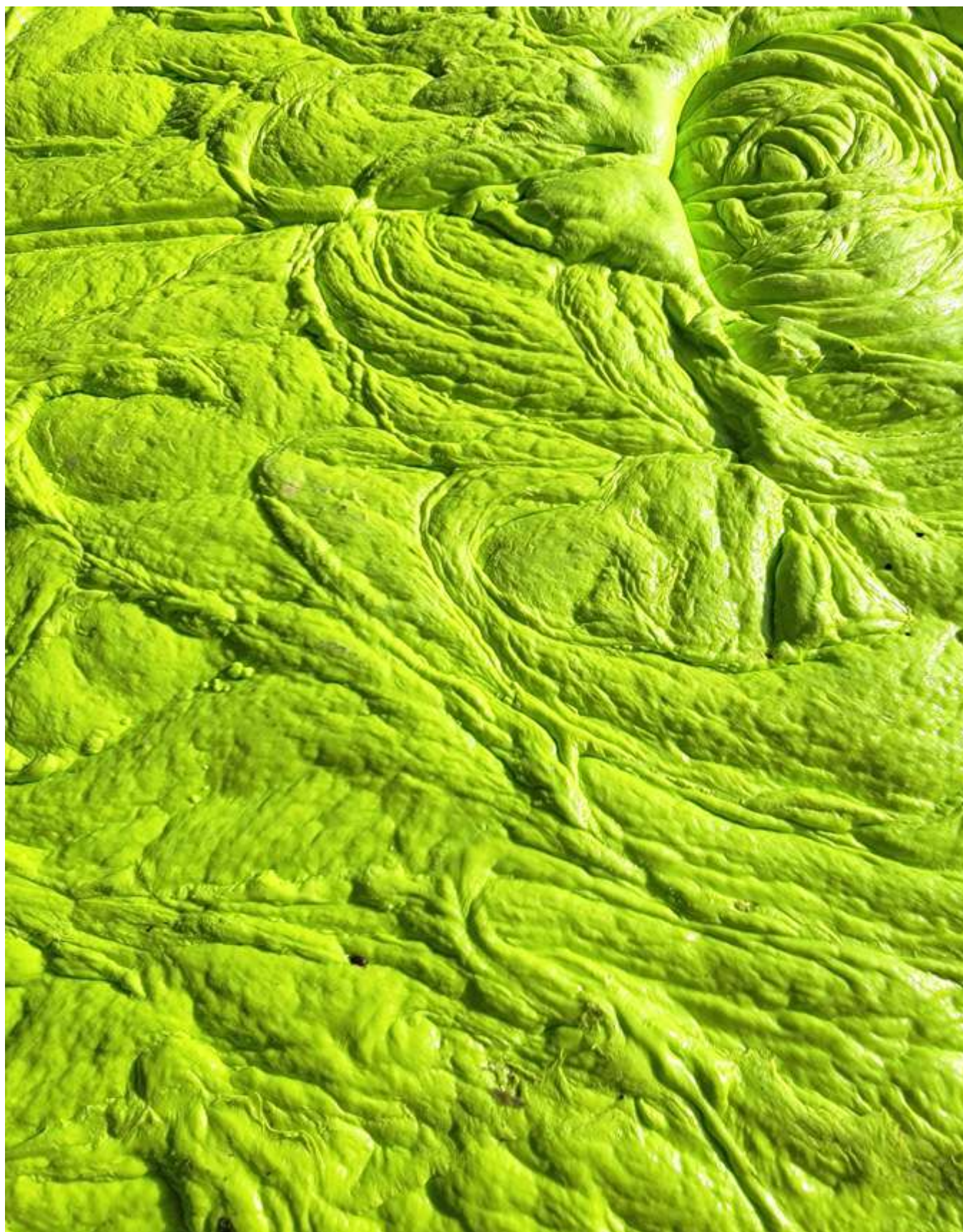
Figura 44. Textura de purga, originada pelo processo de extrusão
