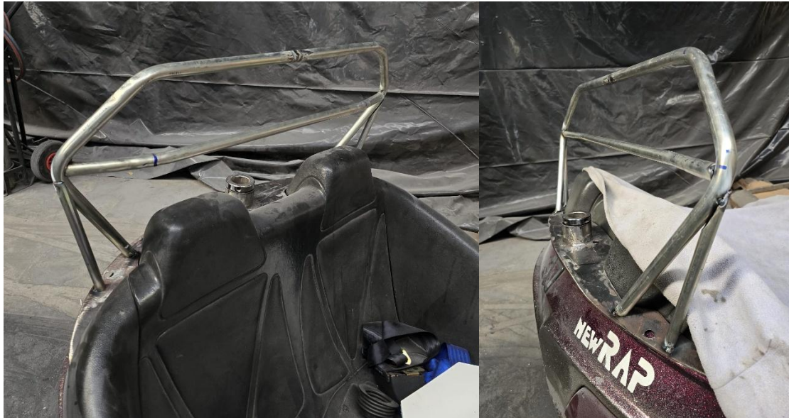
Figura 77 Estrutura tubular aplicada no carro (fonte própria, 2025)
