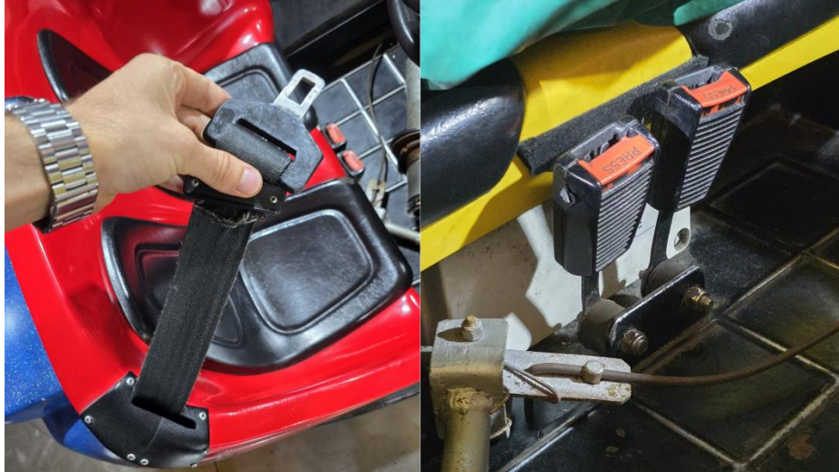
Figura 34 Conjunto de fotografias de um carro para crianças do modelo Maxi Formula com cinto de 2 pontos vertical (fonte própria, 2025)
