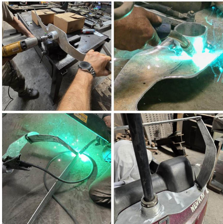
Figura 69 Conjunto de fotografias do processo de produção da estrutura do encosto em alumínio (fonte própria, 2025)
