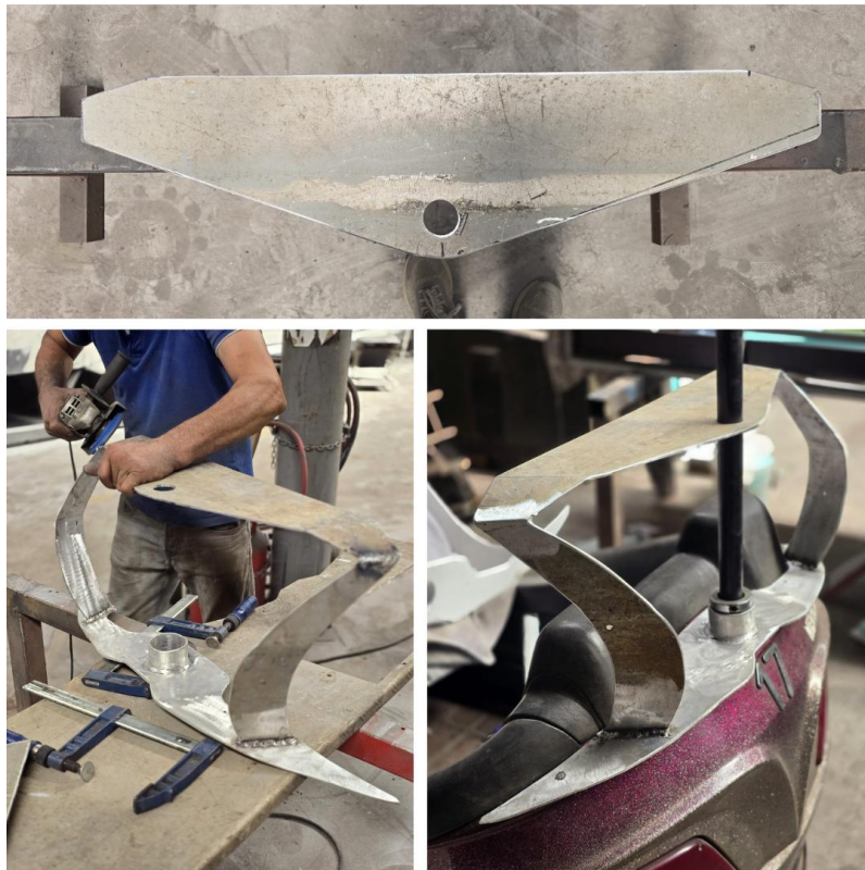
Figura 70 Conjunto de fotografias da peça que unia a estrutura ao troll do carro para dar estabilidade á estrutura (fonte própria, 2025)
