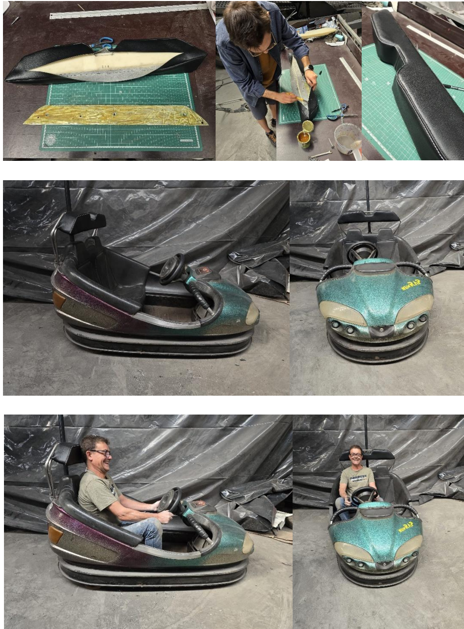
Figura 93 Conjunto de fotografias do processo da aplicação da almofada finalizada (fonte própria, 2025)
