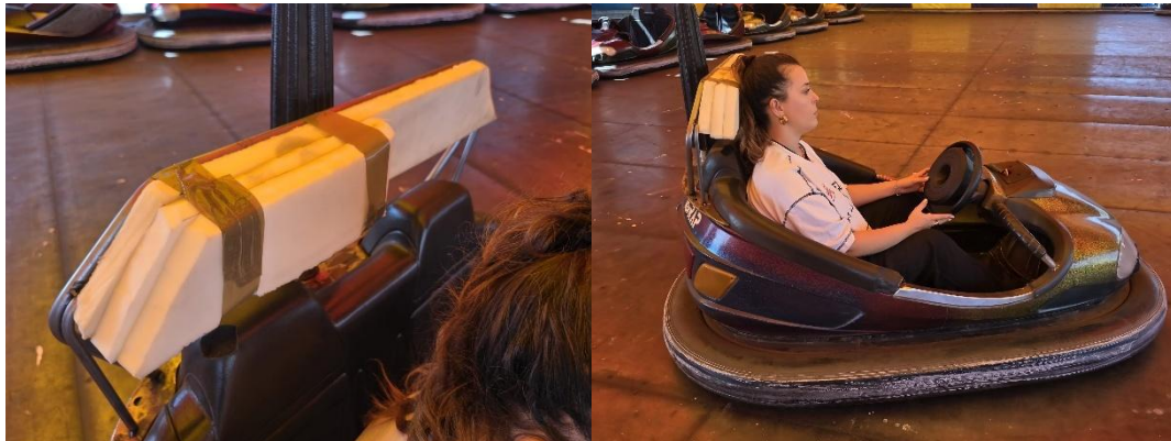
Figura 86 Fotografias da aplicação de uma terceira camada de espuma no encosto (fonte própria, 2025)
