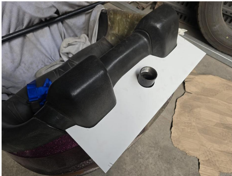
Figura 58 Molde da estrutura do encosto (fonte própria, 2025)
