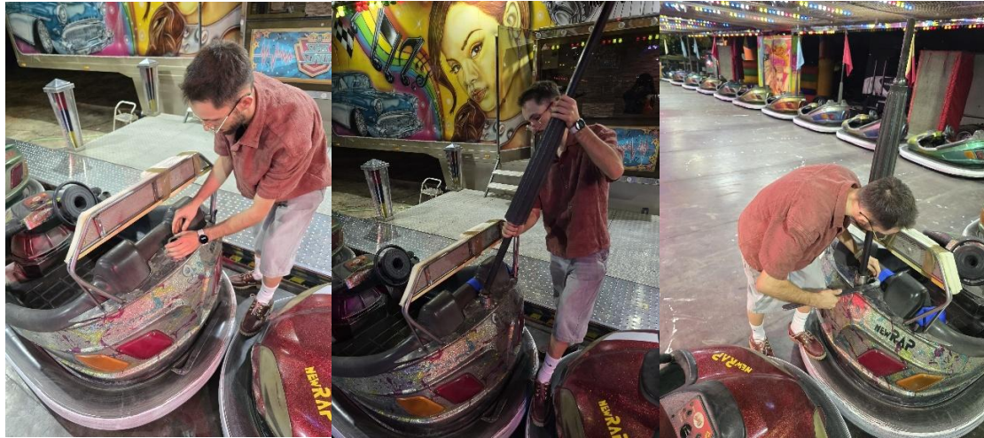
Figura 89 Sequência de fotografias da aplicação do encosto no carro (fonte própria, 2025)
