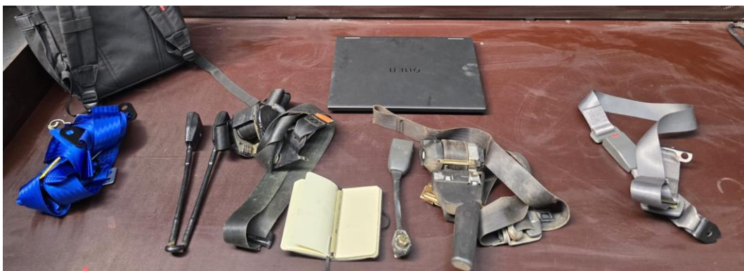
Figura 37 Fotografia da comparação de diferentes cintos de segurança (fonte própria, 2025)
