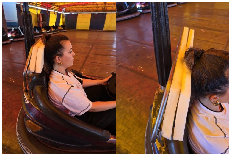
Figura 85 Fotografias da aplicação de uma segunda camada de espuma (fonte própria, 2025)
