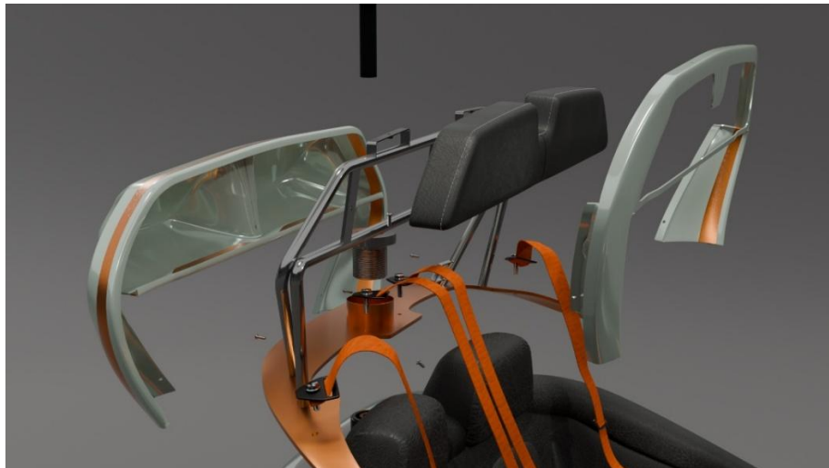
Figura 98 Render da vista explodida do encosto com o cinto de segurança (fonte própria, 2025)
