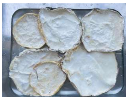
Figura 168 - De seguida, as amostras foram submersas numa solução composta por água e glicerol (20%), por oito horas. Após este processo, foram novamente desidratadas, e finalmente prensadas.
