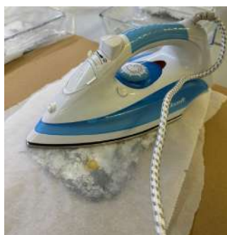
Figura 135 - Procedeu-se à preenssagem da amostra utilizando um ferro de engomar (150°).
