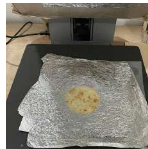
Figura 179 - Processo de prensagem das amostras a cerca de 150°.
