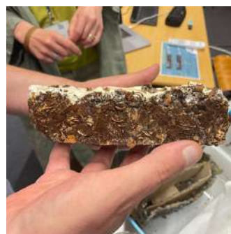
Figura 113 - Estado da amostra após o processo de inativação de desidratação do micélio, realizada por 15 horas a 60 graus celsius.
