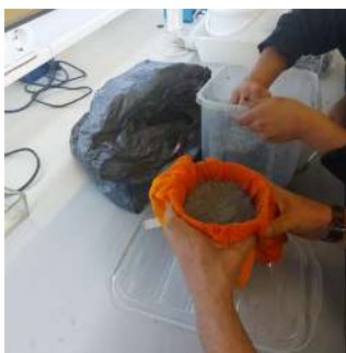
Figura 116 - Eliminação do excesso de água da pasta.
