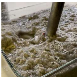
Figura 115 - Após as tiras de papel molhadas, procedeu-se à sua trituração de forma a obter uma mistura uniforme.
