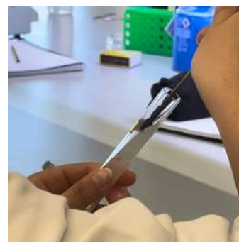
Figura 71 - Utilizando uma agulha, transferiu-se um fragmento para o centro do tubo com PDA.
