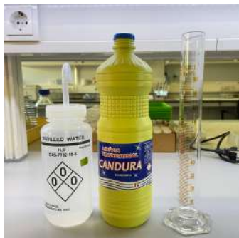
Figura 65 - Realizou-se uma solução numa proveta de 100 ml, com 20 ml de lixívia + 80 ml de água destilada.
