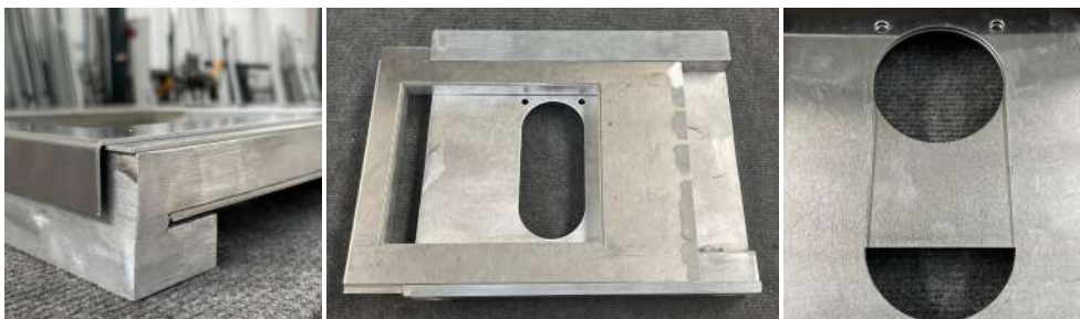
Figura 210 - Estrutura da peça após processo de soldadura. Fotografias da autoria da investigadora.
