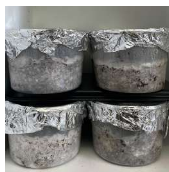
Figura 160 - Cada recipiente foi selado com alumínio, ficando armazenados num local escuro à temperatura ambiente.
