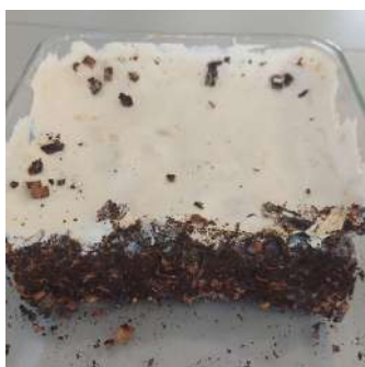
Figura 112 - Nesta amostra, o micélio formou apenas uma rede densa superficial devido à falta de ventilação.
