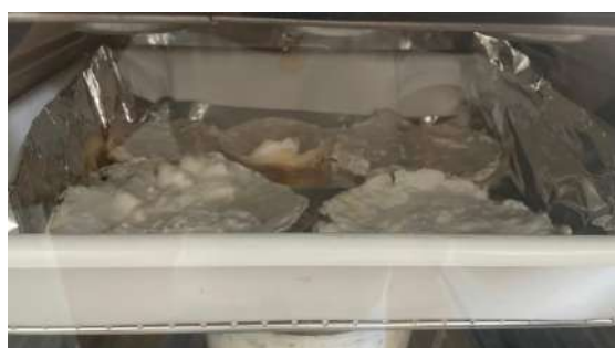
Figura 167 - As amostras foram desidratadas na estufa, durante três horas a 60°. Ainda foram expostas à temperatura ambiente até alcançar a desidratação desejada.
