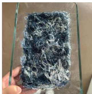
Figura 132 - Preparação de um tabuleiro com a ganga e o café, adicionando 60% de água.
