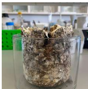
Figura 126 - Inativação e desidratação do micélio: Estufa a 60°C durante 15 horas. No entanto foi necessário prolongar o tempo de desidratação.
