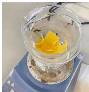
Figura 128 - Preparação da mistura de impermeabilização - Cera de abelha + óleo de girassol + óleo de coco (1:1:1).
