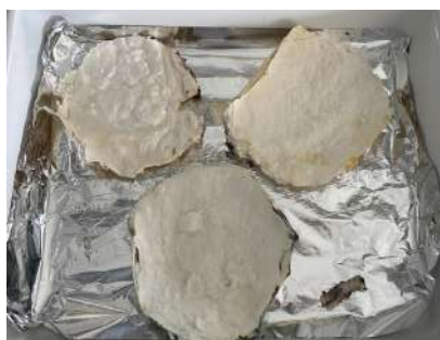
Figura 165 - Neste primeiro pós-processamento, as amostras foram armazenadas na estufa a 40° durante três horas para desidratar.
