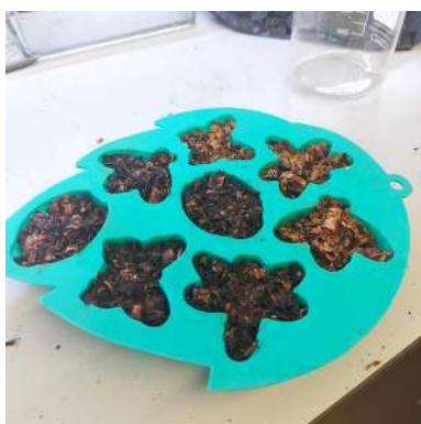
Figura 99 - Distribuição das misturas no molde.
