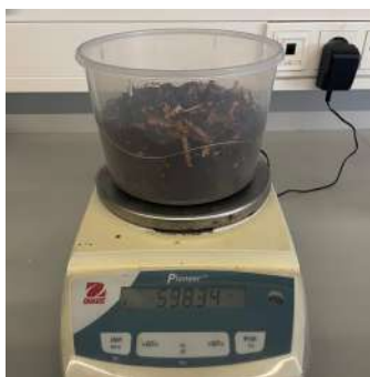
Figura 157 - Foi realizada uma mistura exemplo para identificar a quantidade dos componentes tendo em conta o volume do recipiente.
