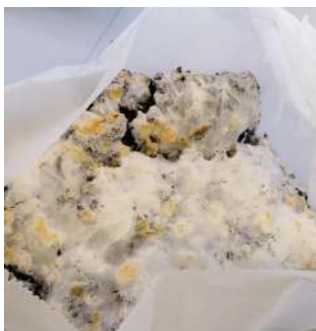
Figura 120 - Após 3 semanas de incubação, o micélio tinha-se espalhado e criado uma camada densa na superfície do molde.
