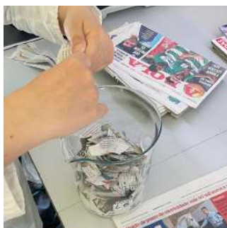
Figura 114 - Preparação do substrato. As tiras de papel adicionou-se água, obtendo uma pasta.
