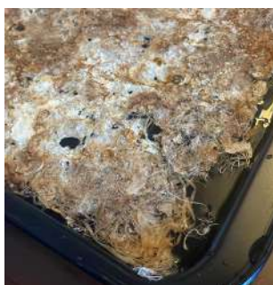
Figura 153 - A amostra foi colocada submersa numa solução aquosa de 20% de glicerol, para adquirir mais flexibilidade.
