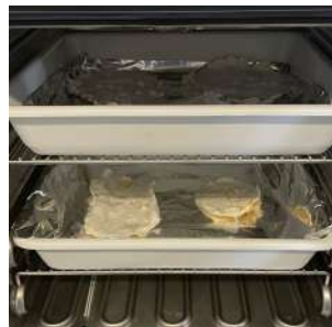
Figura 178 - As amostras foram desidratadas na estufa a 40° durante três horas.
