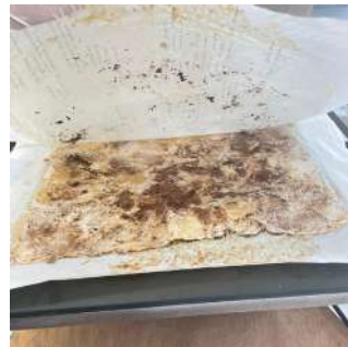
Figura 150 - Amostra após inativação do micélio através de prensagem a quente.
