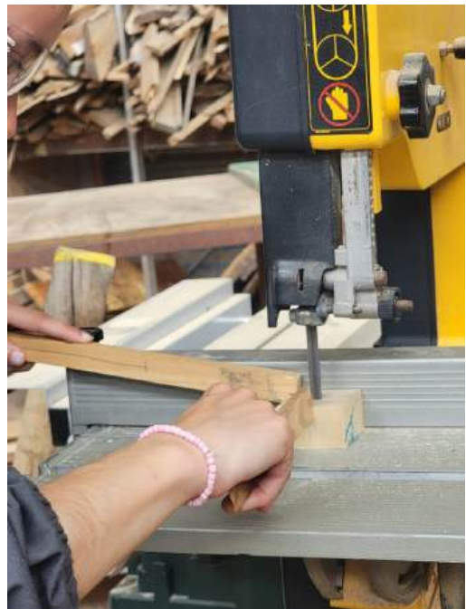
Figura 58: Realização do teste de corte das peças com a serra de fita.
