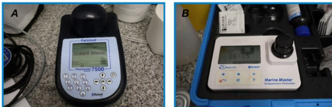
Figura 32 - Equipamentos utilizados para a determinação dos compostos azotados: A) Utilizado na medição dos compostos azotados existentes na água doce; B) Utilizado na medição dos compostos azotados presentes em água salgada.
