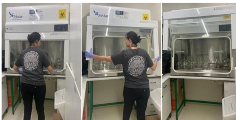
Figura 111 - Abertura da CSB e colocação de material dentro
