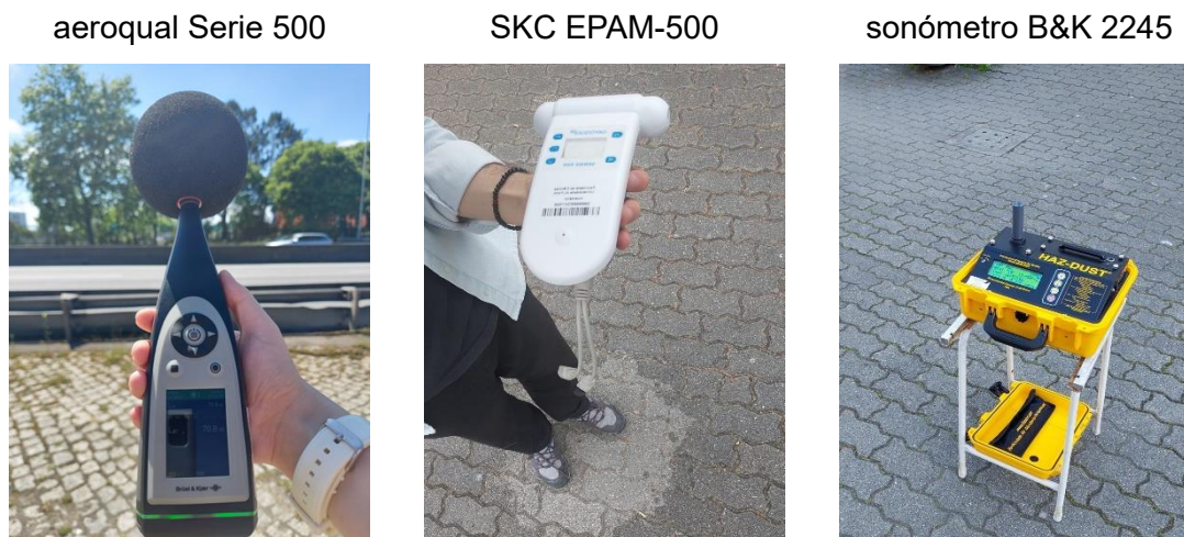
Figura 11 – Equipamentos portáteis utilizados para a determinação da concentração de COV's, NO 2 , O 3 (aeroqual Serie 500), PM 10 (SKC EPAM-500) e ruído (B&K 2245)
