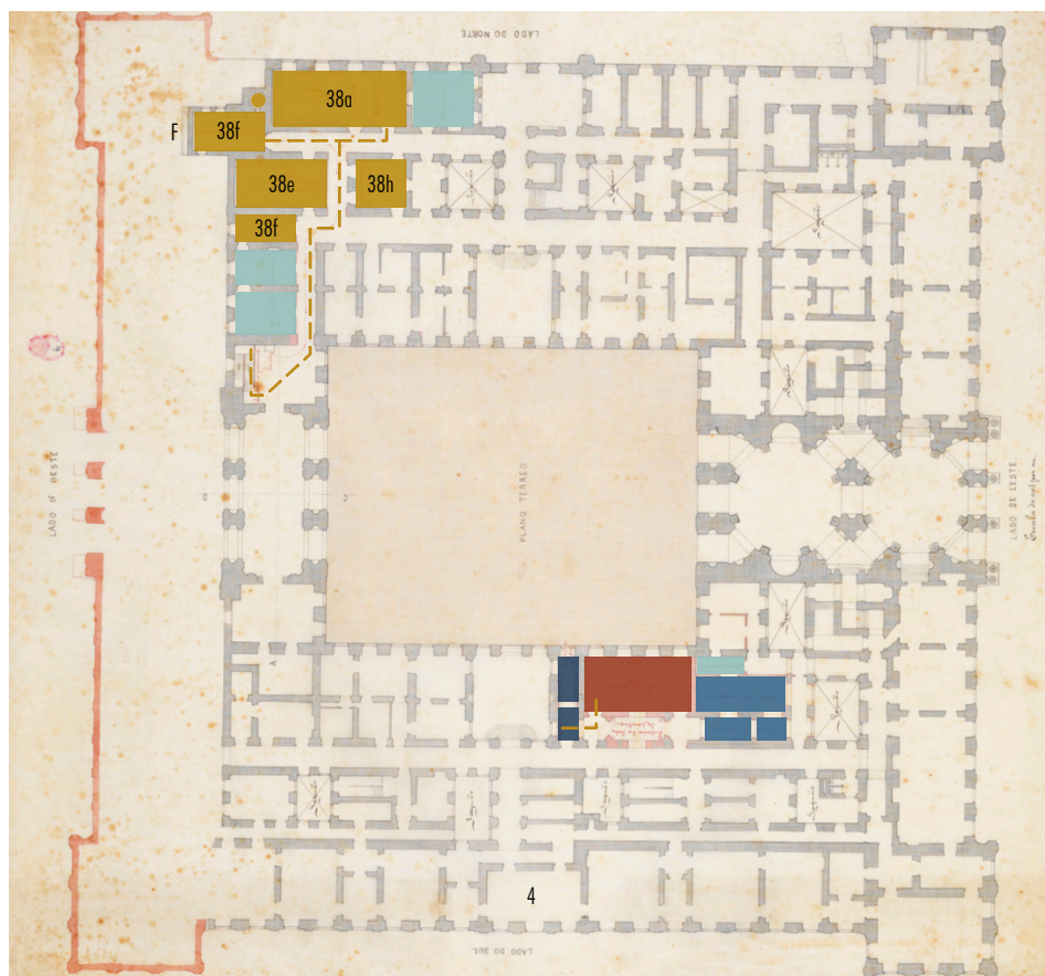
[Fig. 68] Anotações esquemáticas sobre projeto para construção de corredor de ligação entre a cozinha e a nova sala de jantar do Palácio Real da Ajuda: planta do piso térreo, autor desconhecido, anterior a 1865. © BA, Armário de Metal XI, Reg.º 6.
