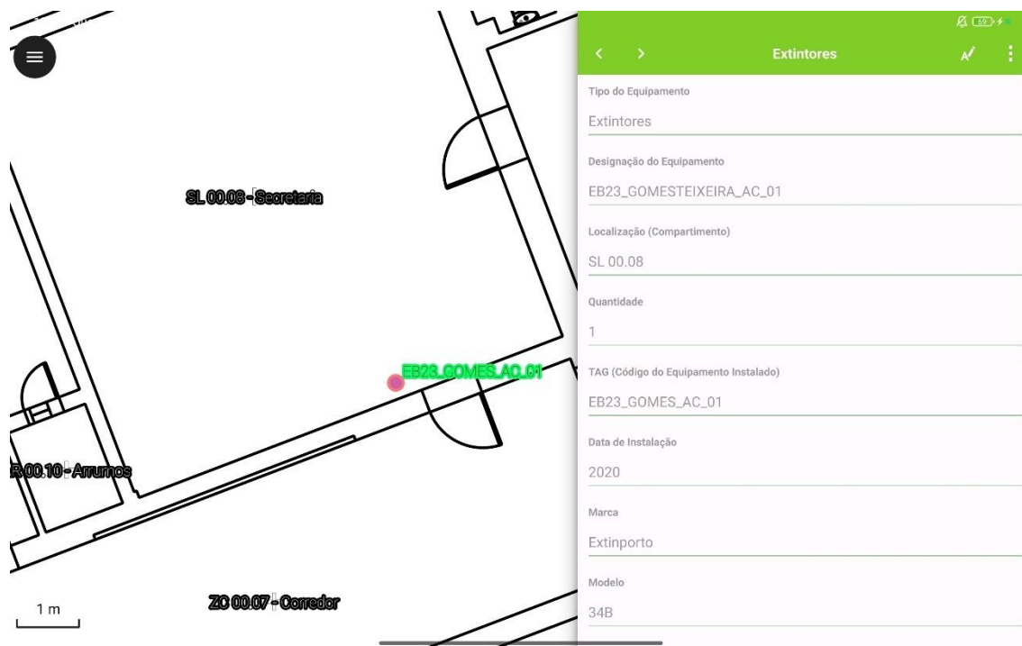
Figura 15 - Levantamento in situ de equipamentos no QField
