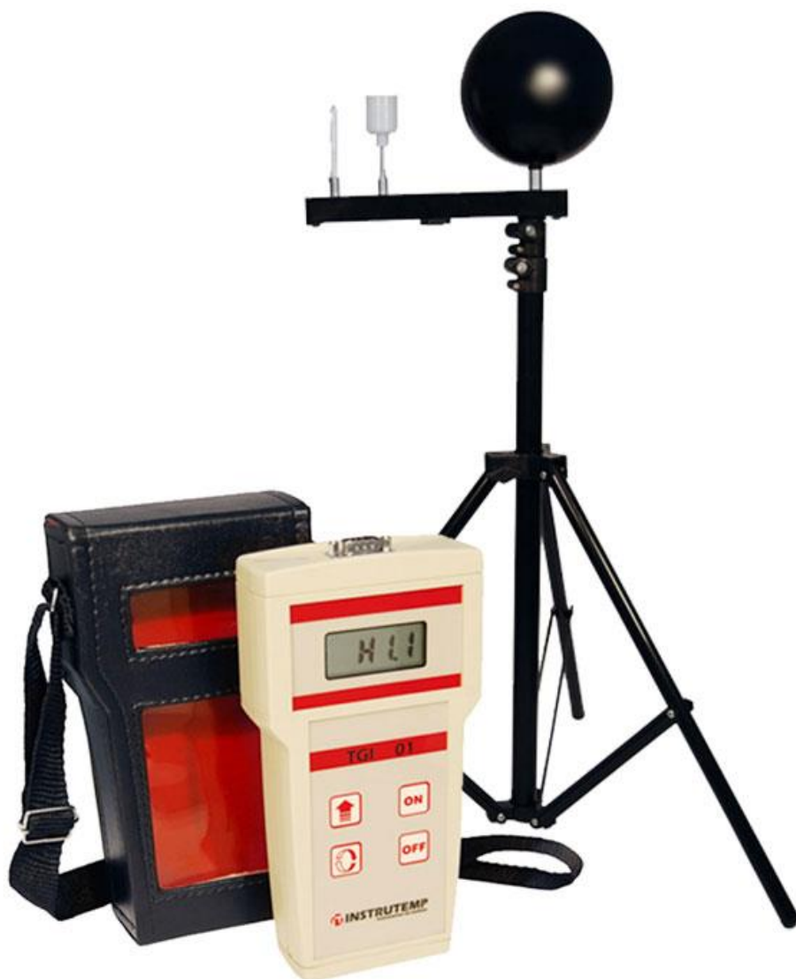
Figura 5- Termómetro de bolbo seco, húmido e de globo negro.
