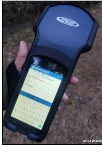
Figura 8. Spectra Precision SP20 - Recetor GNSS portátil de alta precisão, utilizado para levantamentos topográficos.
