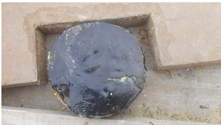
Fig. 157: Lixa P240 e amostra de colofónia (antes do teste). Fonte: Imagem do autor (2025).
