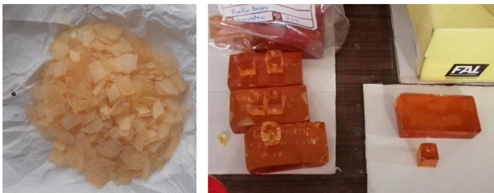
Fig. 6: Colofónia floculada e moldada. Fonte: Imagem do autor (2024).
