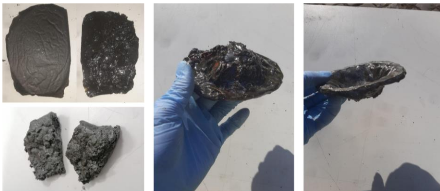
Fig. 48: Galeria de testes exploratórios de mistura de raspa com cinzas. Fonte: Imagem do autor (2025).
