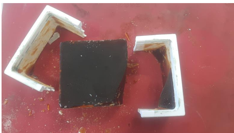
Fig. 128: Remoção da raspa filtrada do molde paralelepípedo. Fonte: Imagem do autor (2025).
