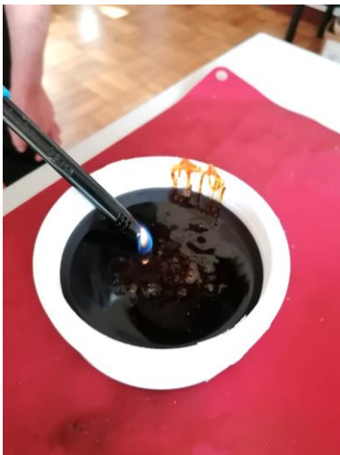
Fig. 126: Remoção de bolhas na raspa filtrada. Fonte: Imagem do autor (2025).
