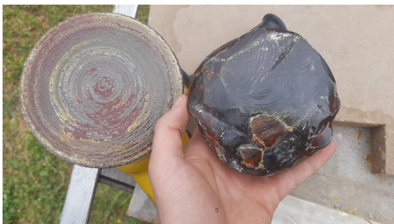
Fig. 147: Lixa P80 e amostra de colofónia (após o teste). Fonte: Imagem do autor (2025).
