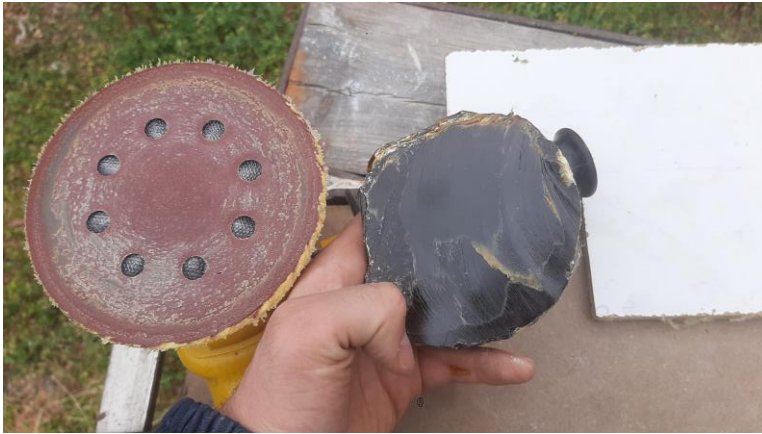
Fig. 152: Lixa P120 e amostra de colofónia (após o teste). Fonte: Imagem do autor (2025).
