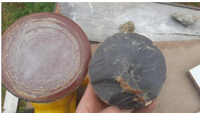
Fig. 156: Lixa P240 e amostra de serrim (após o teste). Fonte: Imagem do autor (2025).
