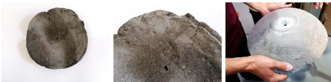
Fig. 205: Resultado do jato de areia, peça de cinzas. Fonte: Imagem do autor (2025).
