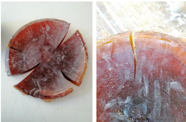
Fig. 177: Conjunto de fotos do teste 1 (Formato H de raspa filtrada fissurada). Fonte: Imagem do autor (2025).
