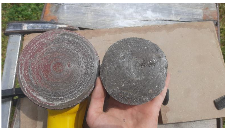
Fig. 142: Lixa P80 e amostra de cinzas (após o teste). Fonte: Imagem do autor (2025).
