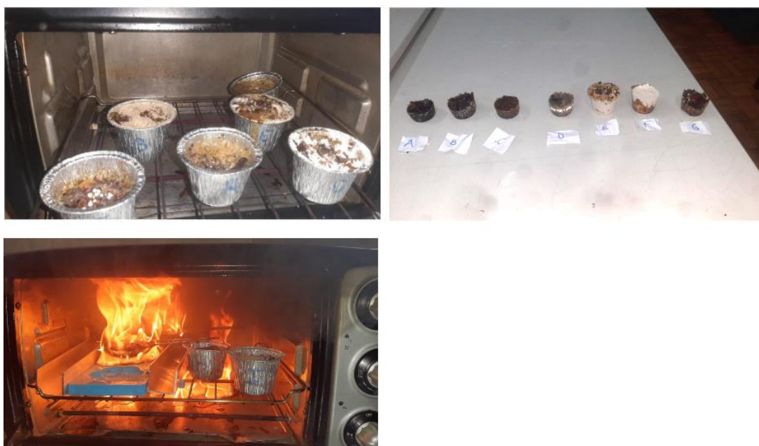
Fig. 51: Galeria de testes exploratórios de raspa misturada com diversos materiais e experiências a arder. Fonte: Imagem do autor (2025).
