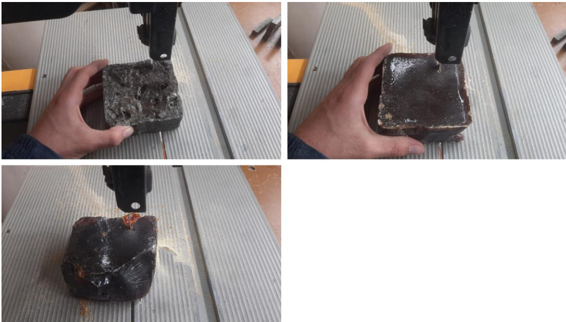
Fig. 136: Provetes com altura de 5cm a serem cortados. Fonte: Imagem do autor (2025).
