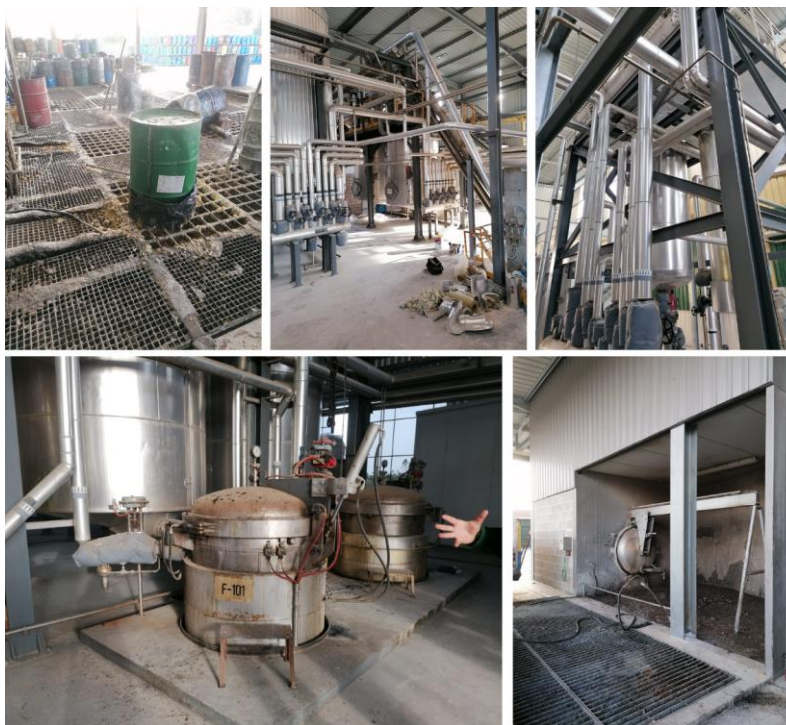
Fig. 21: Parte de terebintinagem (limpeza da resina) na fábrica Nares (Pombal, Portugal). Fonte: Imagem do autor (2024).
