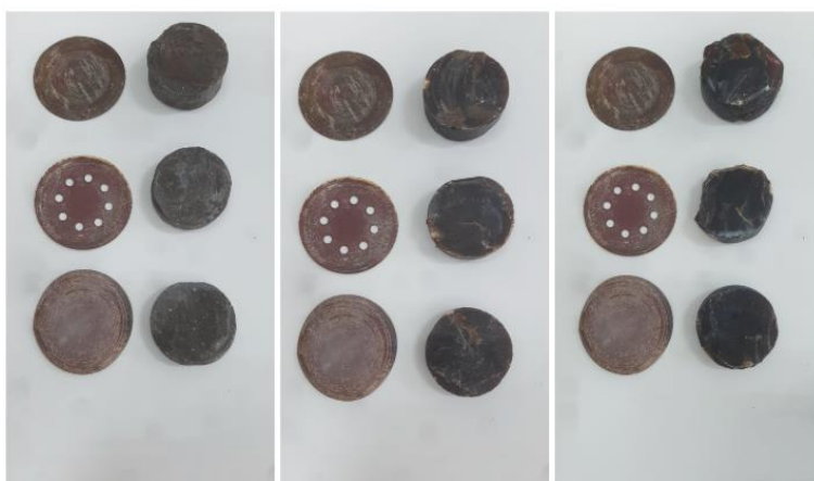
Fig. 4. Resultados dos testes de lixamento (da esquerda para a direita: cinzas, serrim e colofónia). Fonte: Imagem do autor (2025).
