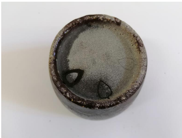
Fig. 209: Resultado da marcação do laser na peça de serrim. Fonte: Imagem do autor (2025).
