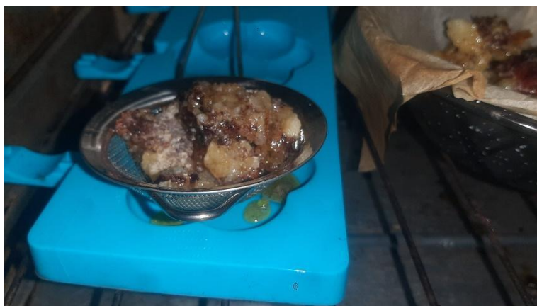
Fig. 57: Primeiras gotas de resina a atravessar o coador. Fonte: Imagem do autor (2025).
