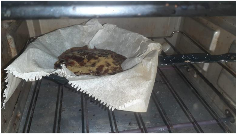
Fig. 54: Separação clara entre resina e as impurezas (a flutuar) aos 7 minutos. Fonte: Imagem do autor (2025).
