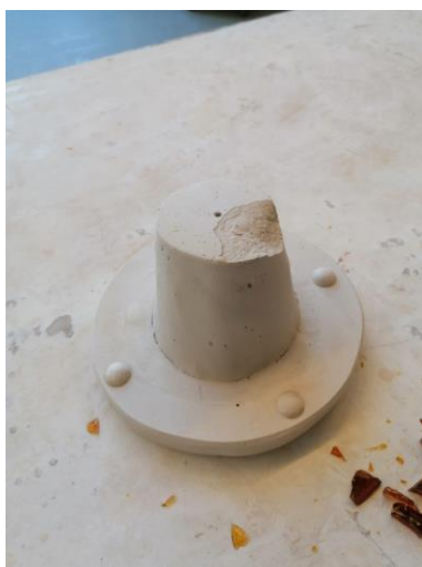
Fig. 194: Contramolde partido. Fonte: Imagem do autor (2025).
