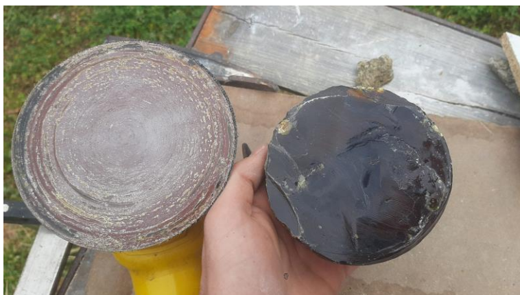
Fig. 158: Lixa P240 e amostra de colofónia (após o teste). Fonte: Imagem do autor (2025).
