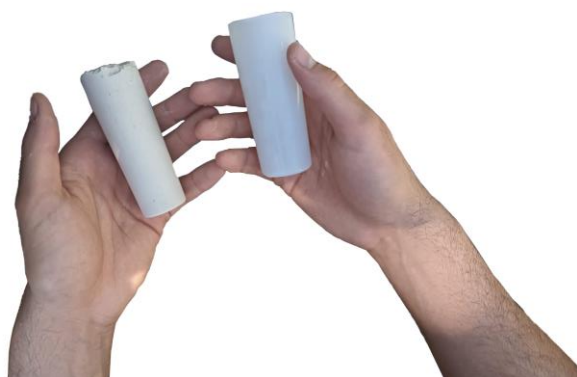
Fig. 167: Preenchimento do contramolde com gesso. Fonte: Imagem da autoria de Tomás Afonso (2025).
