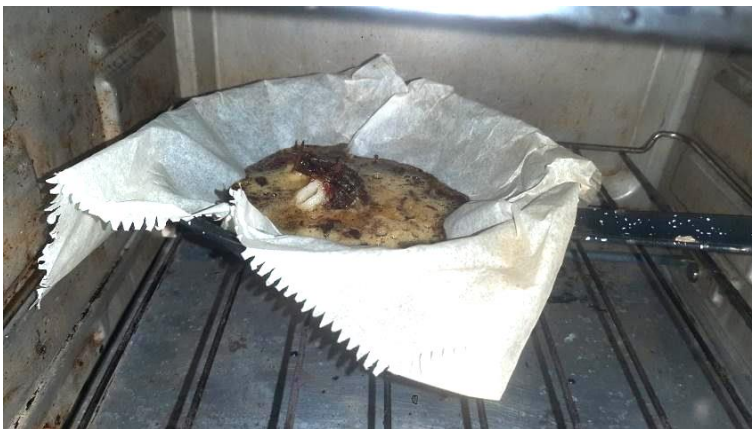
Fig. 53: Alterações de cor da resina após 15 minutos a 150°C. Fonte: Imagem do autor (2025).
