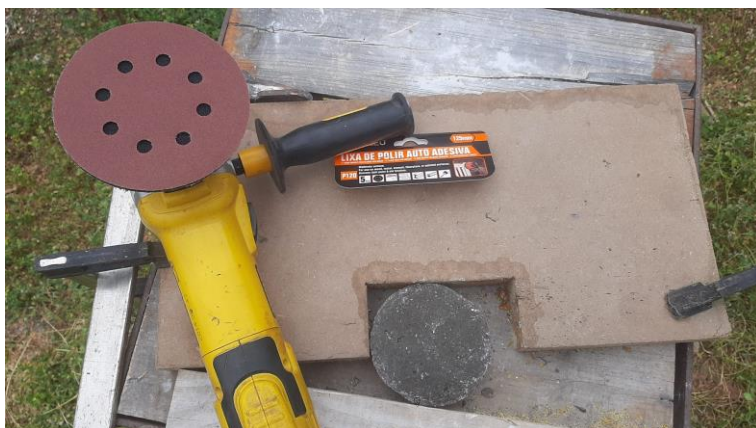
Fig. 148: Lixa P120 e amostra de cinzas (antes do teste). Fonte: Imagem do autor (2025).
