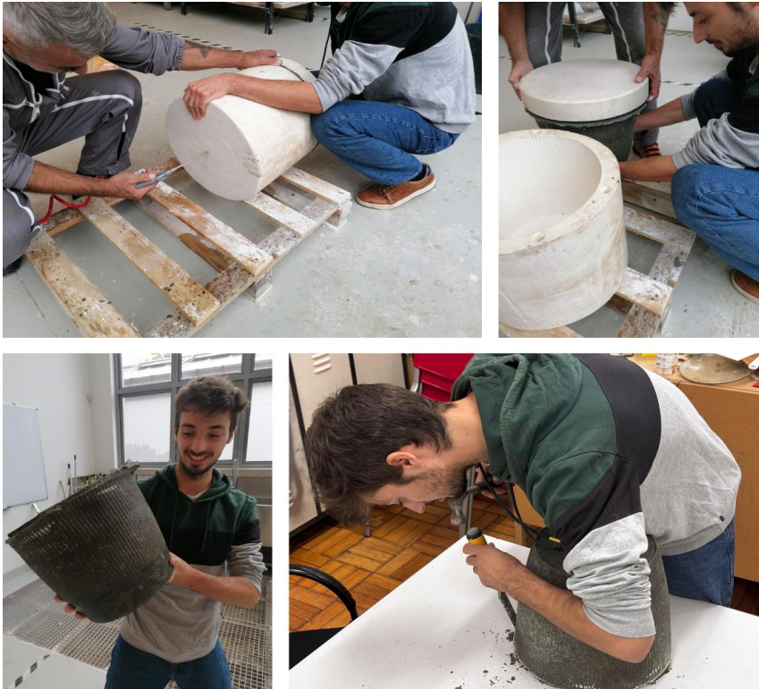
Fig. 213: Desmoldagem e acabamento sobre a peça final. Fonte: Imagem da autoria de Catarina Silva (2025).
