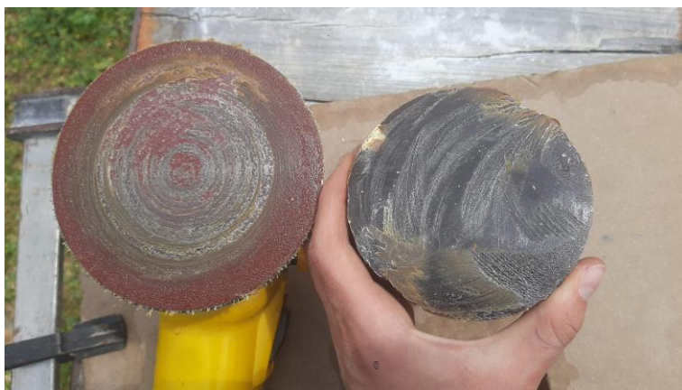
Fig. 144: Lixa P80 e amostra de serrim (após o teste). Fonte: Imagem do autor (2025).
