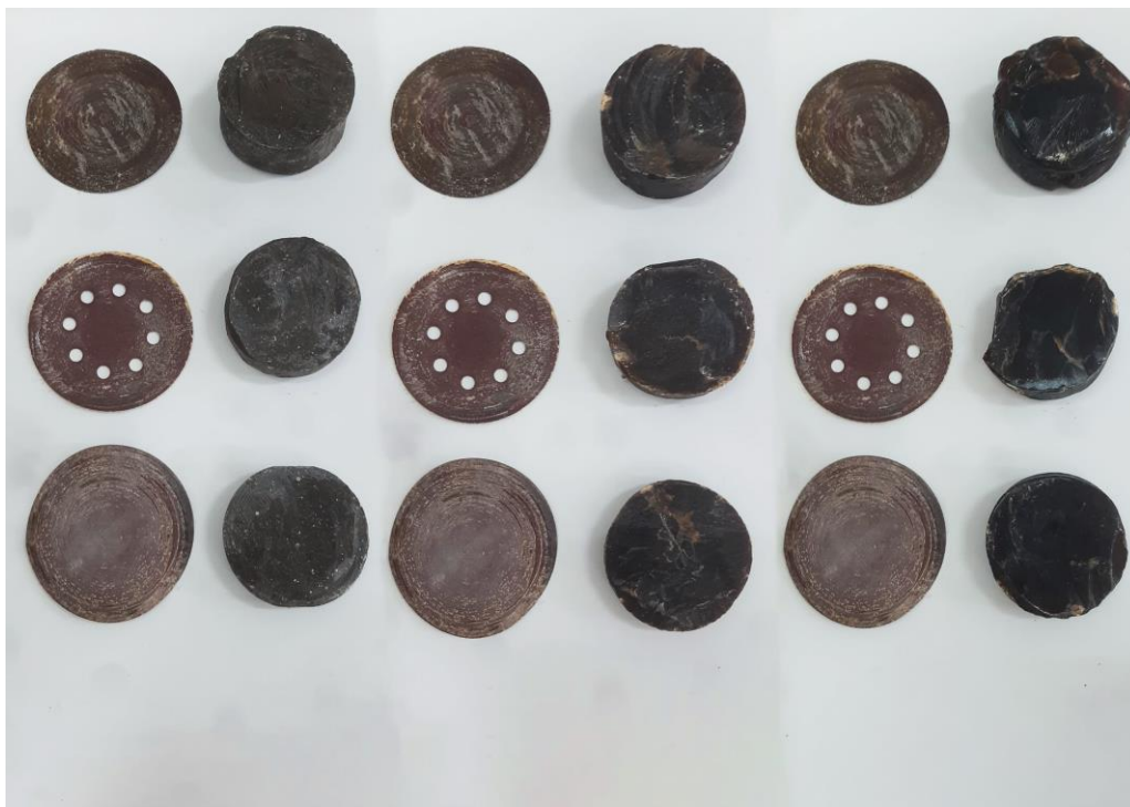
Fig. 160: Resultados dos testes de lixamento (cinzas, serrim e colofónia). Fonte: Imagem do autor (2025).
