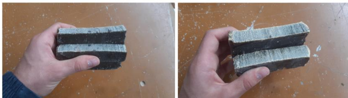
Fig. 138: Resultado do corte nas amostras de 2cm de misturas. Fonte: Imagem do autor (2025).
