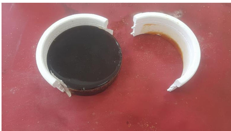
Fig. 127: Remoção da raspa filtrada do molde circular. Fonte: Imagem do autor (2025).
