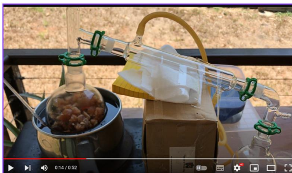
Fig. 28: Processo de destilação de resina caseiro. Fonte: Mo's Maxims (2019).
