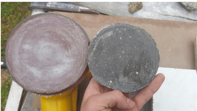
Fig. 154: Lixa P240 e amostra de cinzas (após o teste). Fonte: Imagem do autor (2025).
