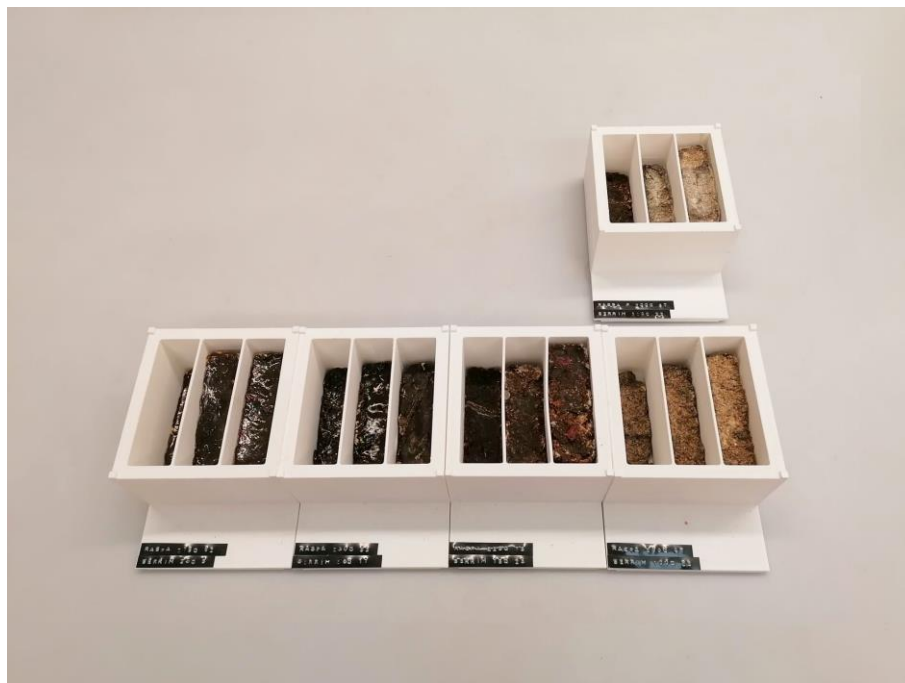
Fig. 103: Testes com serrim: à frente com raspa não filtrada, e atrás com raspa filtrada. Fonte: Imagem do autor (2025).
