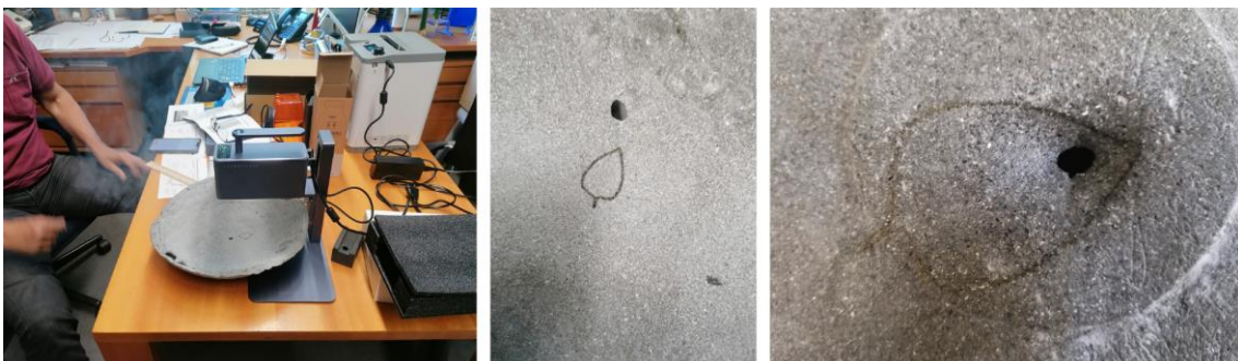
Fig. 208: Resultado da marcação do laser na peça de cinzas. Fonte: Imagem do autor (2025).
