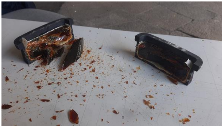
Fig. 64: Peças do teste 2, partidas ao desmoldar. Fonte: Imagem do autor (2025).
