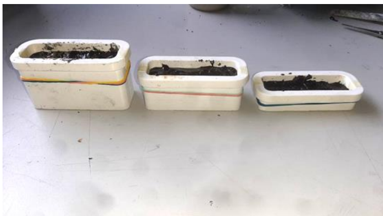
Fig. 68: Mistura despejada nos Moldes teste 3. Fonte: Imagem do autor (2025).
