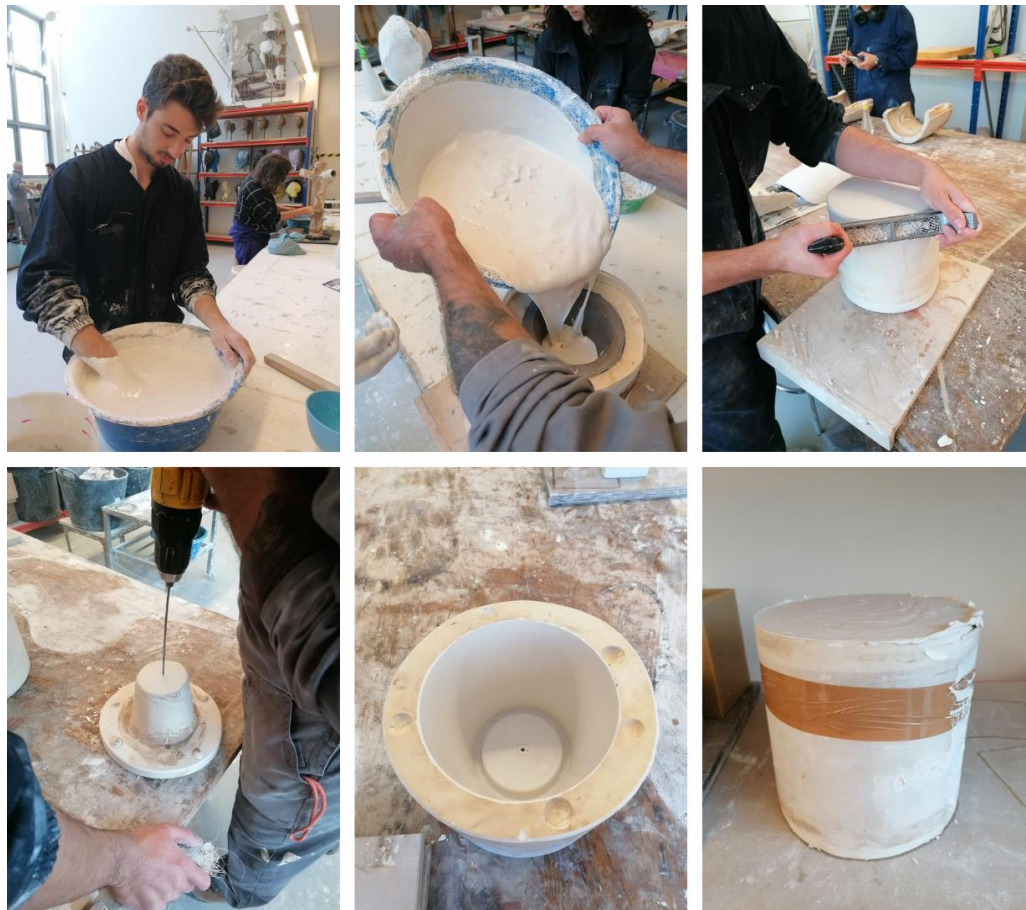
Fig. 173: Sequência de imagens captadas durante a fase de criação do molde. Fonte: Imagem da autoria de Catarina Silva (2025).
