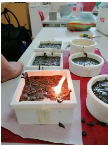
Fig. 125: Remoção de bolhas na mistura de cinzas. Fonte: imagem do autor (2025).
