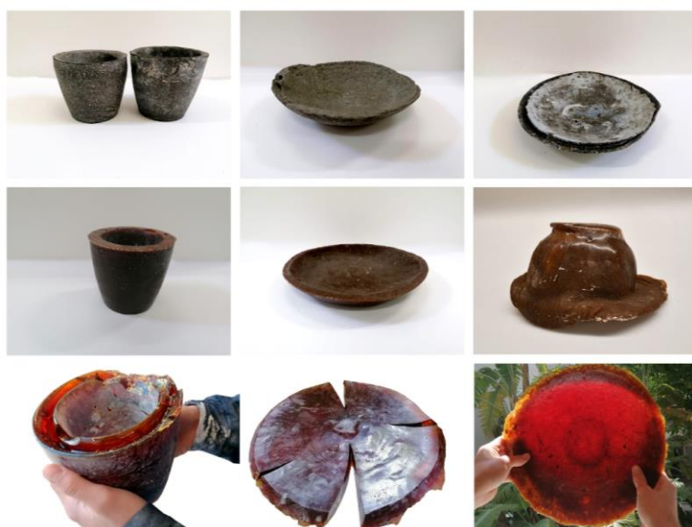
Fig. 5. Resultados dos testes em moldes de gesso (linha 1: cinzas, linha 2: serrim, linha 3: colofónia e fibras). Fonte: Imagem do autor (2025).
