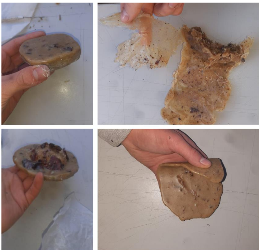
Fig. 50: Galeria de testes exploratórios de mistura de raspa com cera de abelha. Fonte: Imagem do autor (2025).
