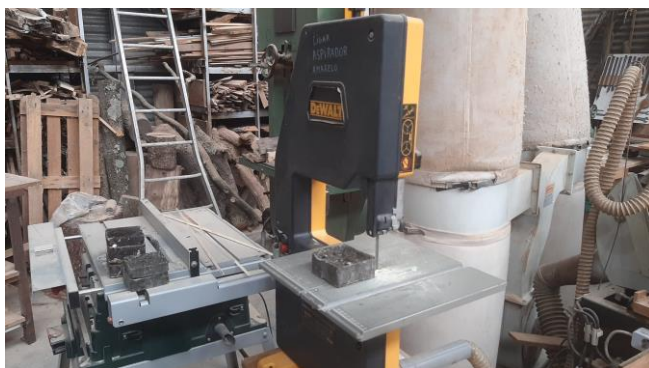
Fig. 134: Máquina de serra vertical. Fonte: Imagem do autor (2025).
