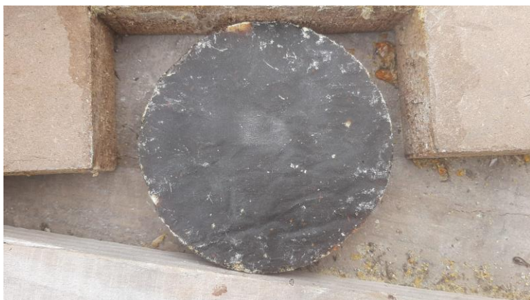
Fig. 155: Lixa P240 e amostra de serrim (antes do teste). Fonte: Imagem do autor (2025).
