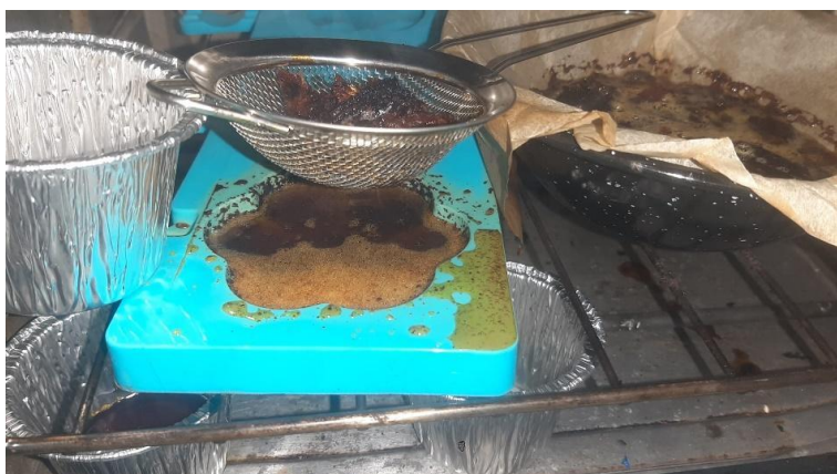
Fig. 60: Raspa completamente derretida a superfície com metade com bolhas. Fonte: Imagem do autor (2025).
