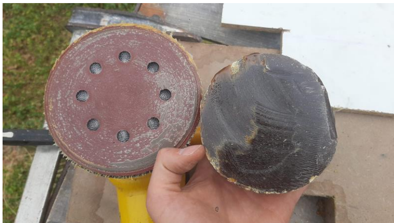
Fig. 150: Lixa P120 e amostra de serrim (após o teste). Fonte: Imagem do autor (2025).
