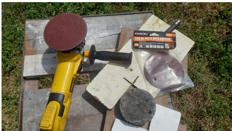
Fig. 141: Lixa P80 e amostra de cinzas (antes do teste). Fonte: Imagem do autor (2025).
