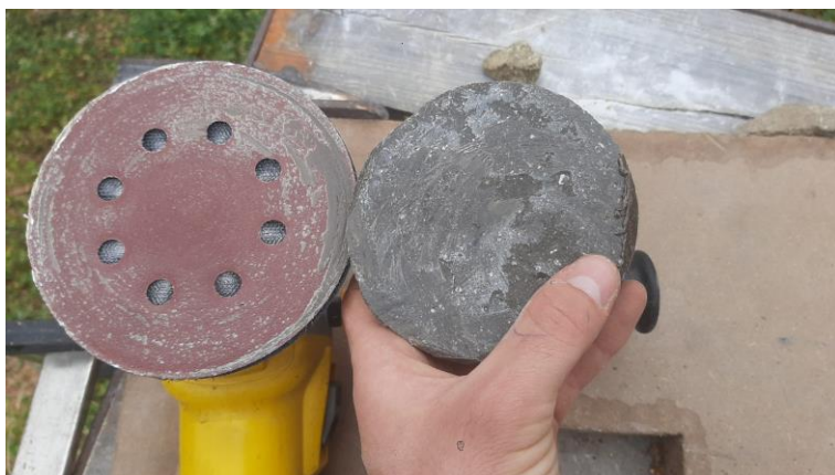
Fig. 149: Lixa P120 e amostra de cinzas (após o teste). Fonte: Imagem do autor (2025).
