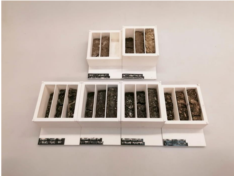
Fig. 89: Testes com cinzas: à frente com raspa não filtrada e cinzas não peneiradas, e atrás com raspa filtrada e cinzas peneiradas. Fonte: Imagem do autor (2025).
