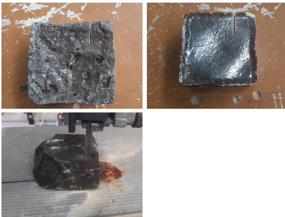
Fig. 137: Resultado do corte nas amostras de 5cm de altura. Fonte: Imagem do autor (2025).
