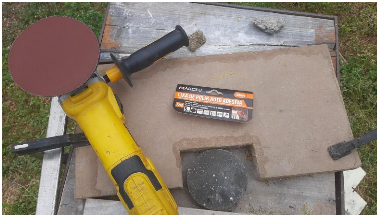
Fig. 153: Lixa P240 e amostra de cinzas (antes do teste). Fonte: Imagem do autor (2025).
