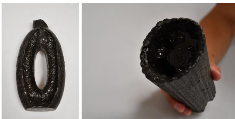
Fig. 164: Cavidades formadas após secagem. Fonte: Imagem do autor (2025).
