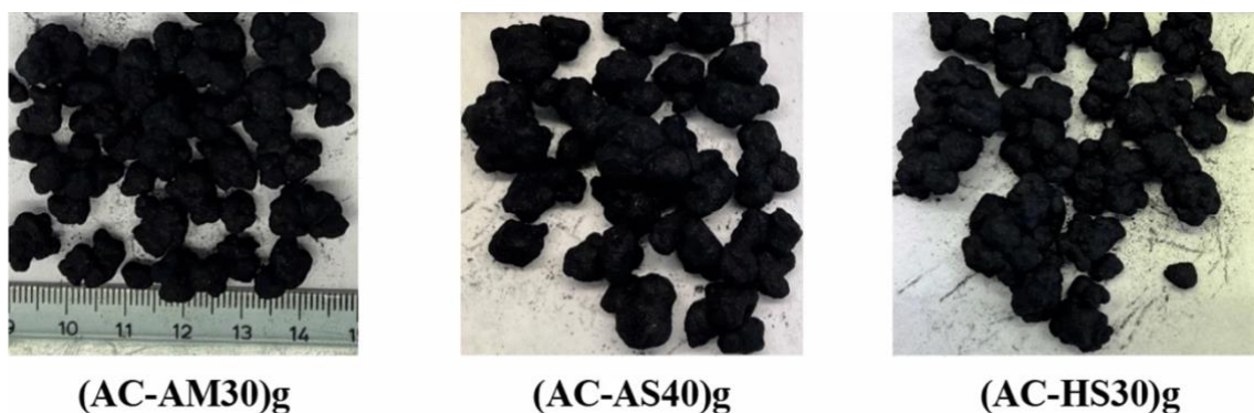
Figura 11. Imagens dos grânulos formados com aglutinantes de silicato preparados a partir de sílicas coloidais Ludox® (AS-40, AM, HS30), evidenciando a integridade estrutural, a uniformidade de tamanho e a ausência de fissuras ou fragmentação após as etapas de secagem e estabilização térmica. Fonte: Mourão et al. [60].
