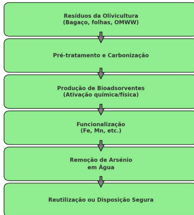
Figura 3. Fluxograma do processo de valorização de resíduos da indústria do azeite para a produção de bioadsorventes. Fonte: Elaboração própria.
