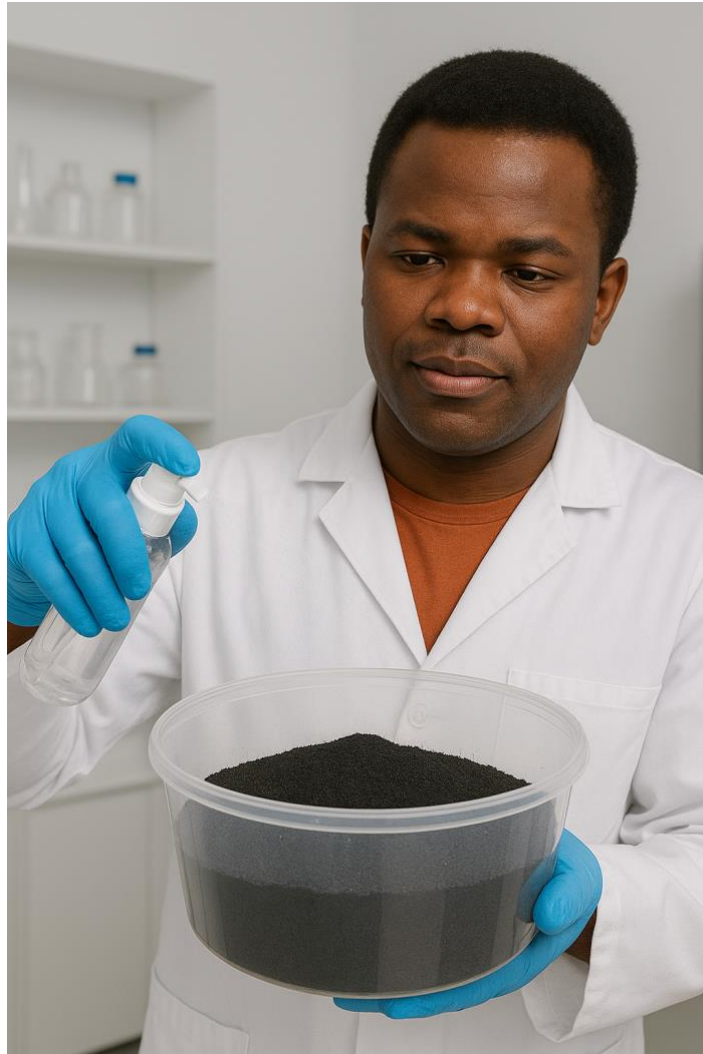
Figura 10. Processo de granulação do (AC)p por espalhamento do aglutinante líquido.
