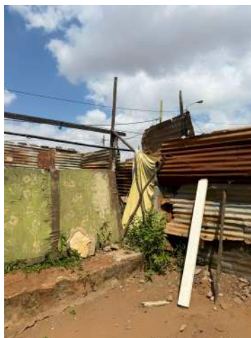
Fig. 81. No próprio quintal são improvisadas casas de banho e espaços de estar, maioritariamente com chapas metálicas, lonas e paus de madeira. Os moradores recorrem também à pedra para delimitar espaços, apoiar as estruturas ou até mesmo impedir que as águas da chuva possam descer para o interior.
