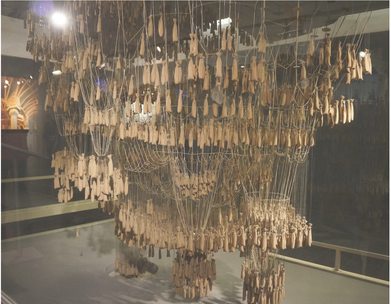
02| Um modelo de força invertida da Colônia Güell. Fonte: parametric-architecture
