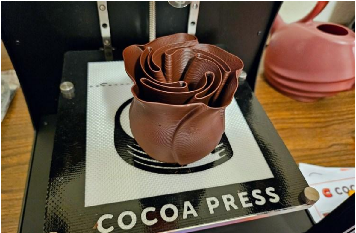
Figura 4 – Pétala de uma flor impressa em 3D usando chocolate como filamento
