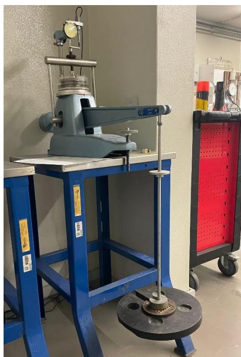
Figura 44 - Edómetro Wykeham Farrance do LabGeo da FEUP
