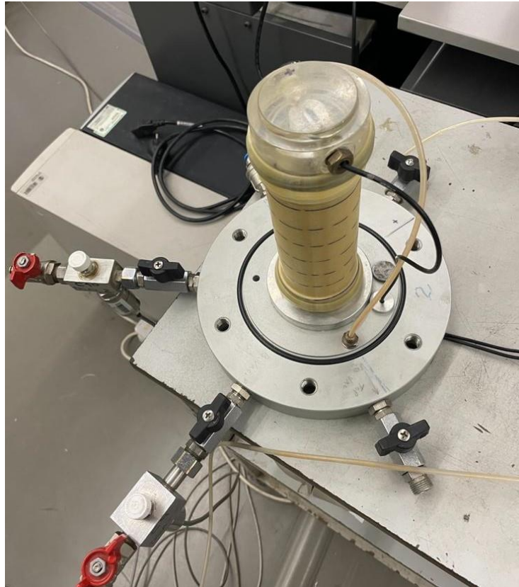
Figura 37 -Câmara triaxial convencional com montagem concluída
