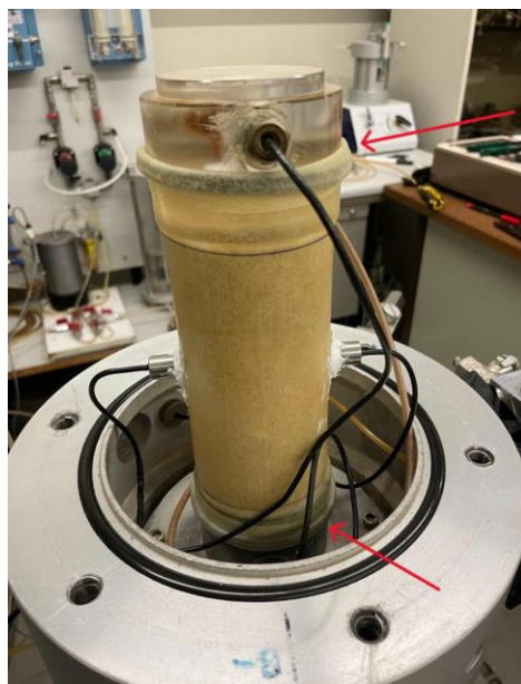
Figura 36 – Disposição dos transdutores piezocerâmicos no topo e na base do provete
