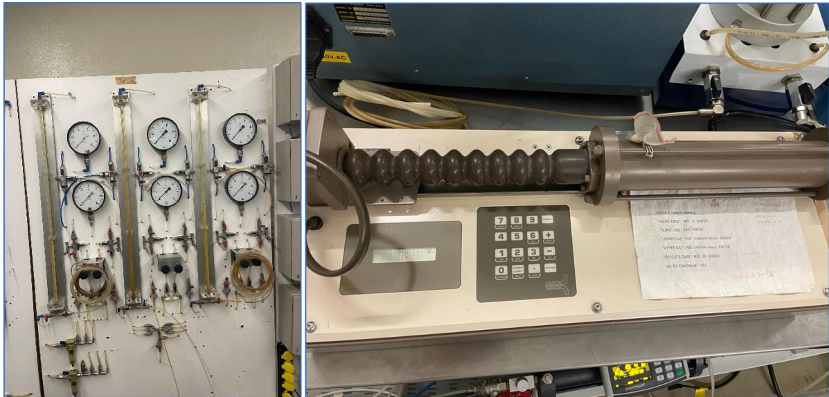
Figura 35 – Controlo da pressão, BP e CP de forma manual e de forma automática com recurso a um GDS
