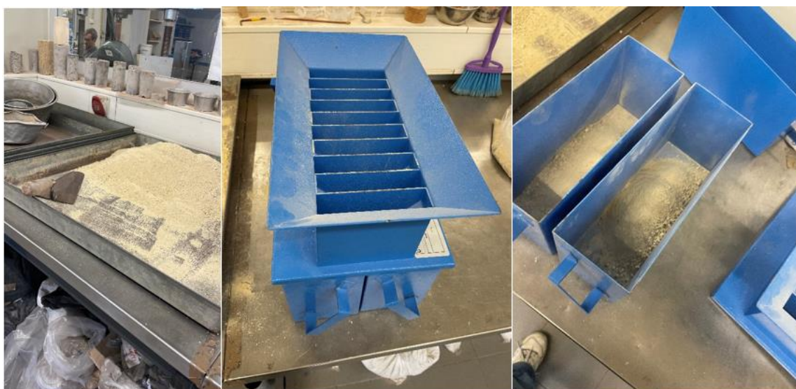
Figura 22 - Imagens do processo de esquartelamento da amostra com a utilização de um esquartelador
